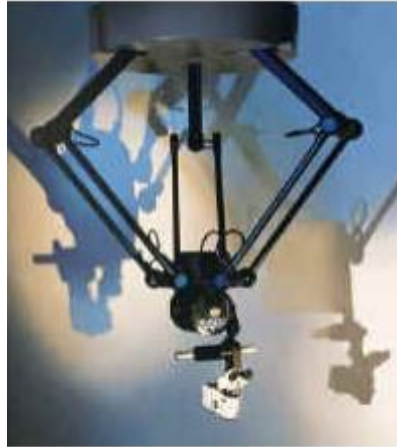
Figura 3 SurgiScope. Robot Delta en aplicaciones médicas.
