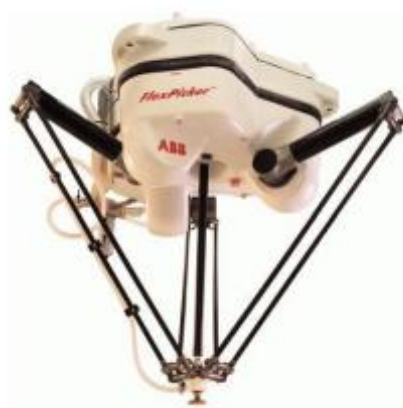
Figura 4 IRB 340. Robot con arquitectura delta una solución de ABB para operaciones de “pick-and-place”.
