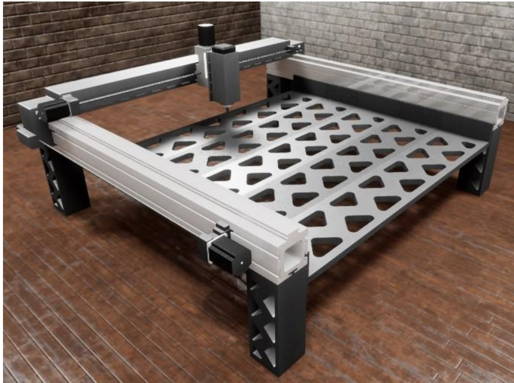
Figura 60. Prototipo de fresadora CNC portable ensamblada.
