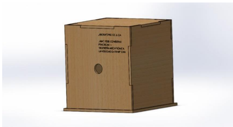
Figura 27, propuesta Caja aislamiento Térmico, software Soliwork, (Fuente: Autor)
