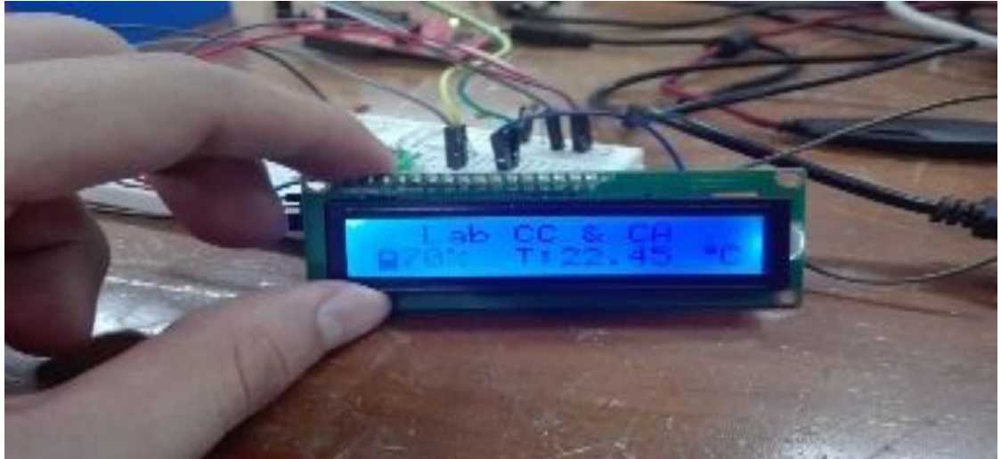
Figura 71, visualización final, estado de carga, temperatura interna del horno donde se encuentra la referencia de tensión, (fuente: autor).
