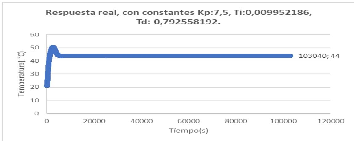
Figura 50, Resposta real con constantes Kp:7.5, Ti:0,009952186, Td: 0,792558192, (Fuente: Autor)
