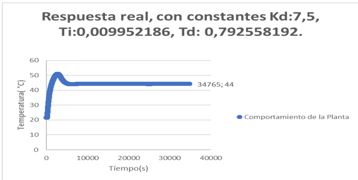
Figura 49, Respuesta real con constantes Kp:7,5, Ti:0,009952186, Td: 0,792558192, (Fuente: Autor)
