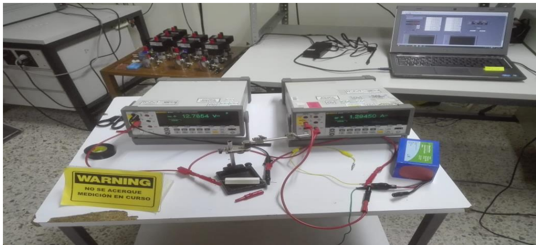
Figura 57-montaje real con resistencia de 10 ohm, (Fuente: Autor)
