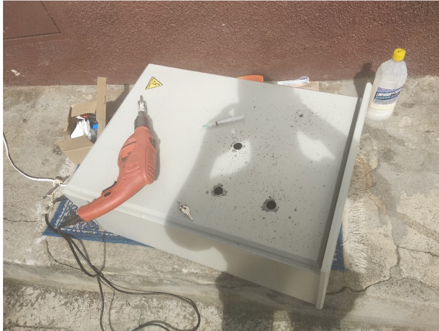
Figura 27. Proceso de fabricación de la estructura del cofre
