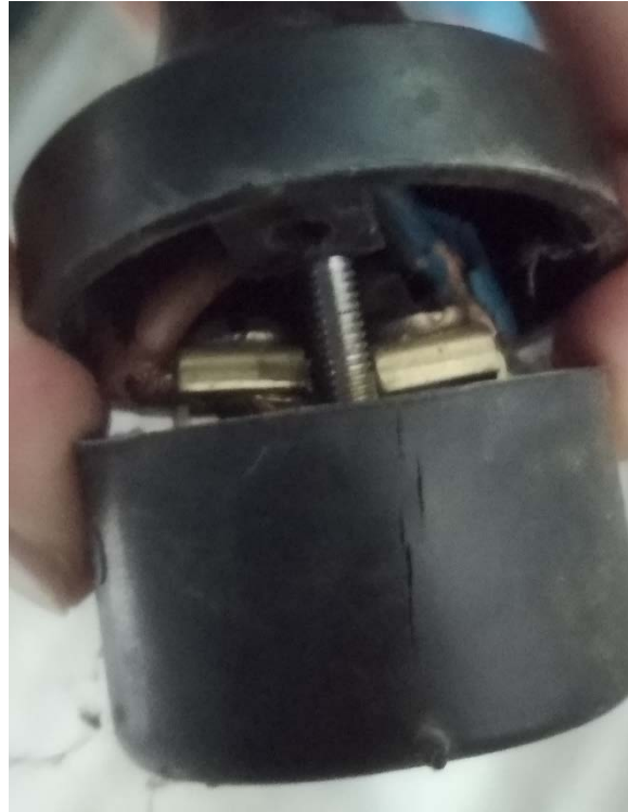
Figura 43. Conector en bomba de vacío.
