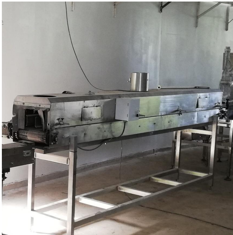
Figura 42. Túnel Exhausting. (Fuente: Autor).
