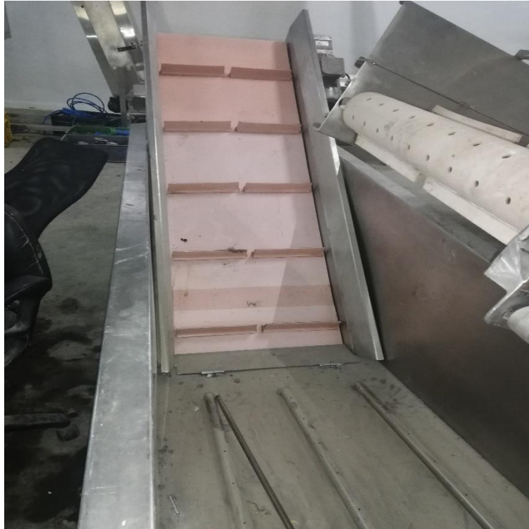
Figura 35. Lavado por ácido nítrico. (Fuente: Autor).
