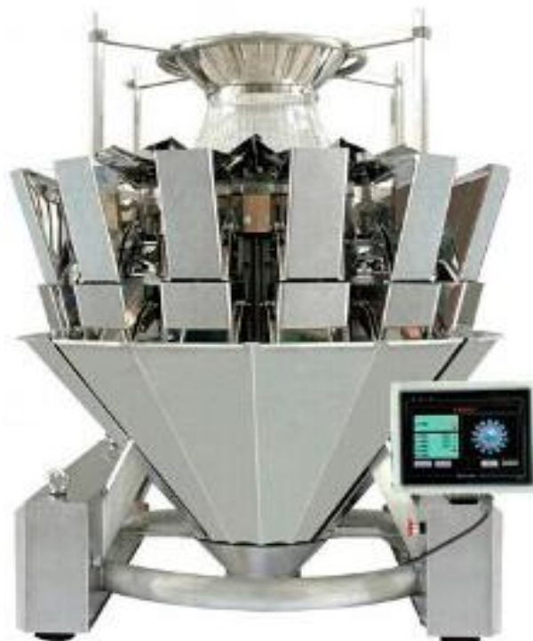
Figura 11. Multicabezal industrial de 14 cabezales. (Fuente: https://www.mirpack.es ).
