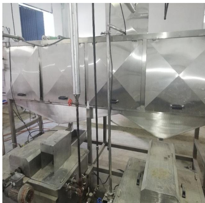
Figura 31. Lavado por agua y escobillas. (Fuente: Autor).
