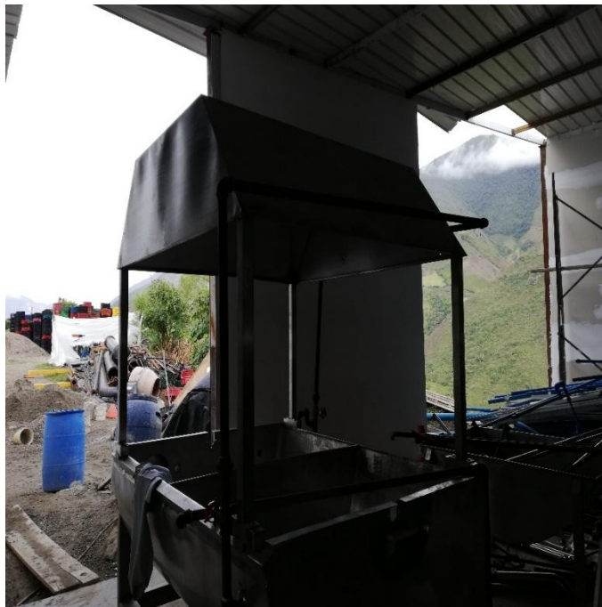
Figura 27. Tanque de lavado por soda caustica. (Fuente: Autor).
