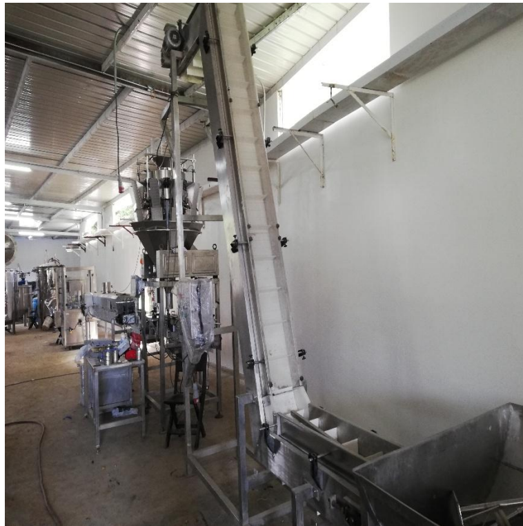
Figura 36. Tanque y banda elevada. (Fuente: Autor).
