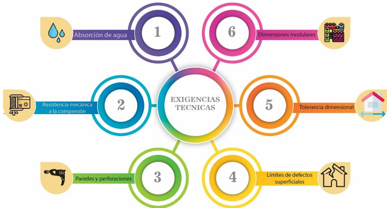
Ilustración 4 Exigencias técnicas para elaborar un ladrillo en materiales reciclados fuente: elaboración propia a partir de la revista invi 2008
