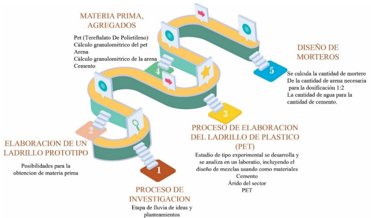
Ilustración 6 Proceso para la elaboración de ladrillos con materiales alternativos fuente: elaboración propia a partir de la revista invi 2008
