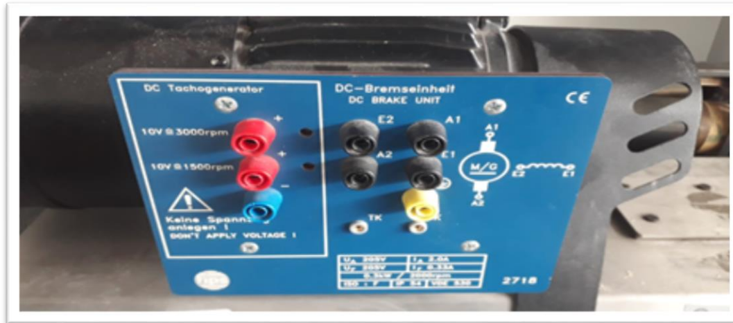
Figura 14 Taco- generador. (Autor)
