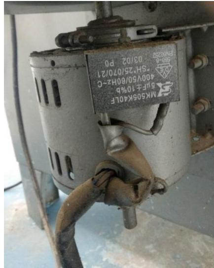
**Figura 14.** Motor monofásico horno deshidratador de la empresa ASOPROCAB.
