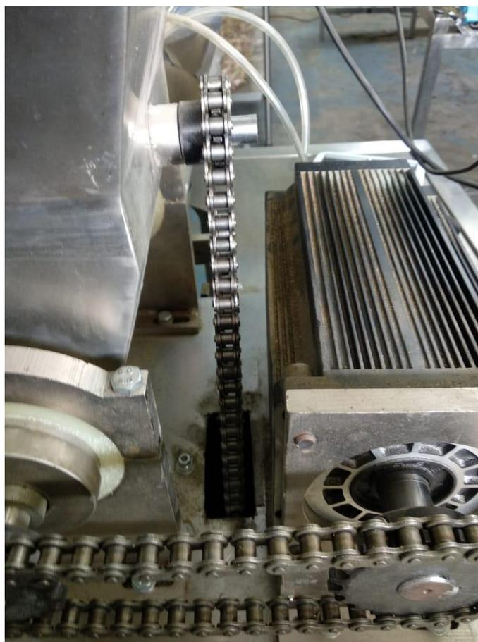
**Figura 49.** Sistema de dosificación de material.
