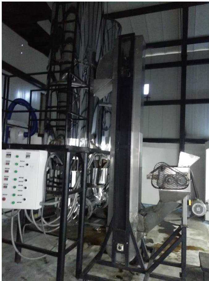
**Figura 40.** Deshidratador de la empresa junto con picadora de cebolla.
