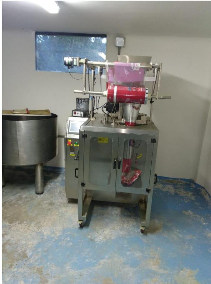
**Figura 42.** Maquina dosificadora empacadora de la empresa.
