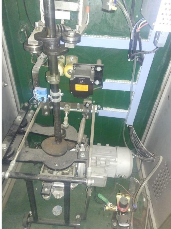
**Figura 48.** Sistema de movimiento de empacado de la máquina dosificadora empacadora.
