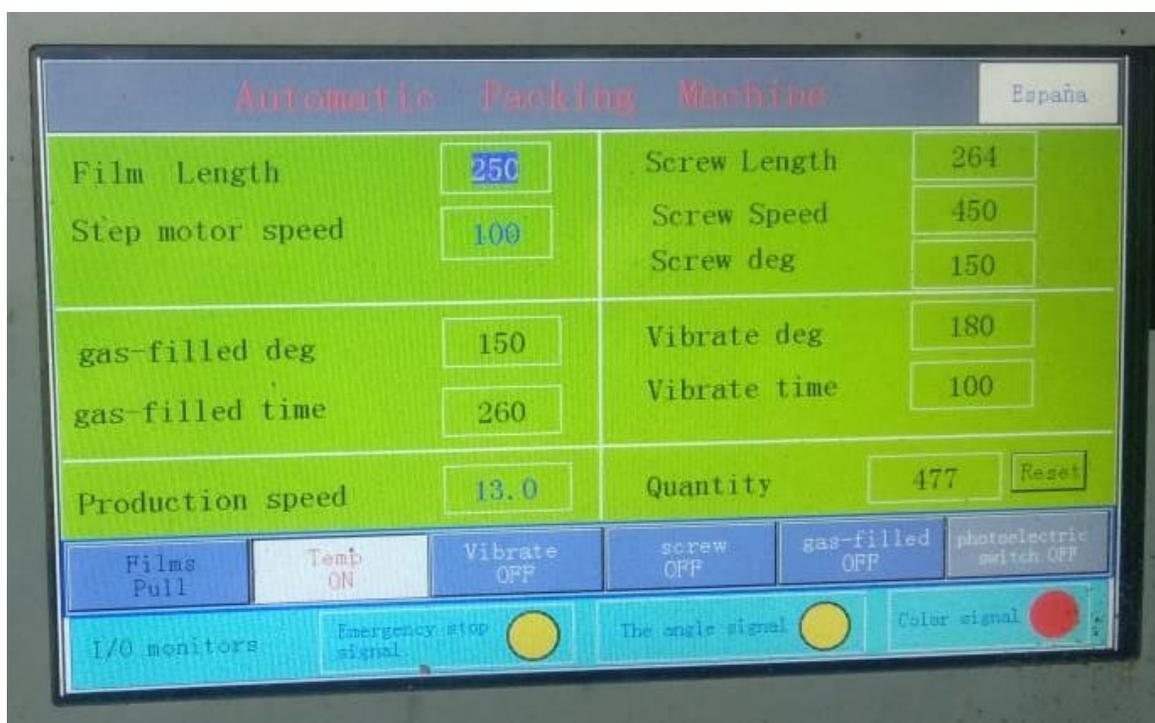
**Figura 43.** Configuración para empacado de 125 gramos.
