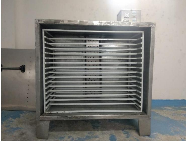
**Figura 20.** Cámara del horno secundario, empresa ASOPROCAB.
