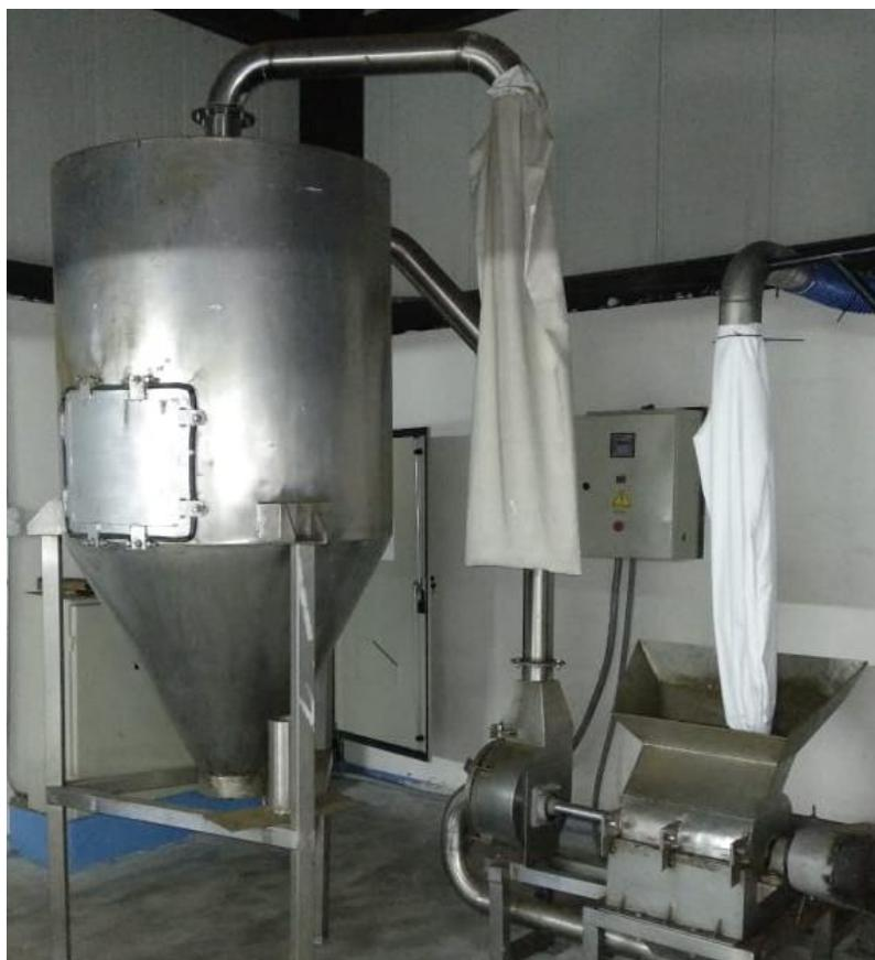
**Figura 41.** Pulverizador de cebolla deshidratada de la empresa.
