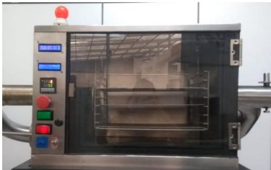
Figura 10: Deshidratador con el control implementado Autores
