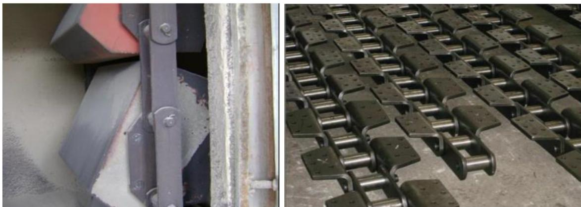
**Figura 2-4.:** Cadena (órgano de tracción de un Elevador por cangilones).[3].
