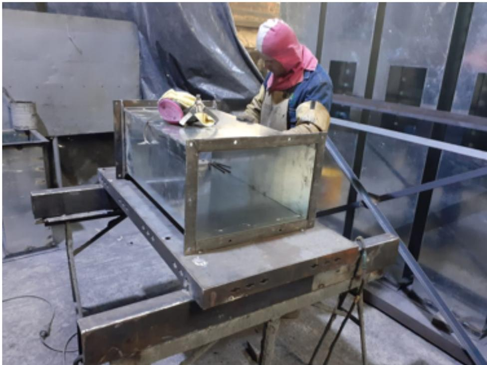
**Figura 3-3.:** Pierna de ajuste fijada al mesón metálico: Fuente: Taller de fabricación EQUIM S.A.S, Bucaramanga- Santander .
