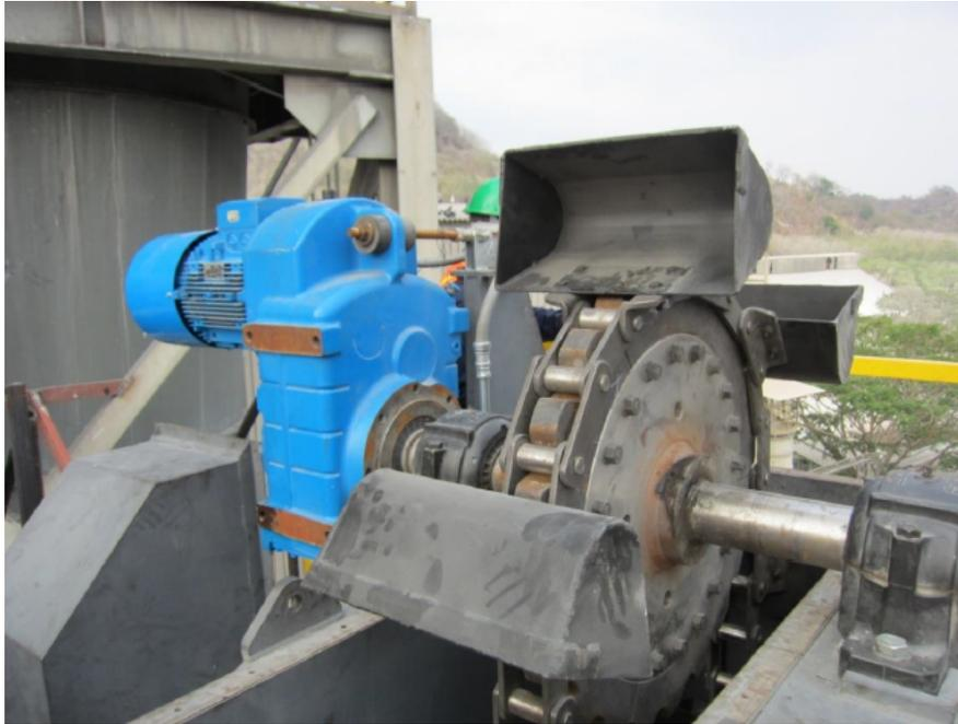
**Figura 2-2.:** Sistema de accionamiento de un elevador de cangilones[3].
