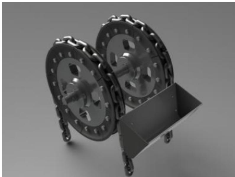
**Figura 2-6.:** Elevador de cangilones con cadenas como órgano de tracción.[3].
