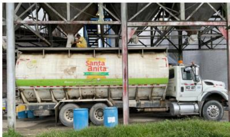
Imagen 1. Granelero con capacidad para 15 toneladas de alimento.
