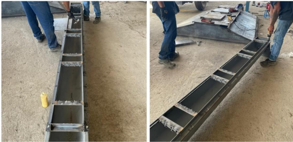
Imagen 14. Adecuación de las compuertas para control de flujo.
