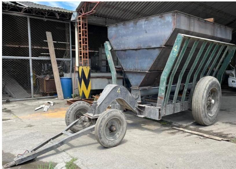
Imagen 20. Sistema tolva y estructura para remolcar la carga.
