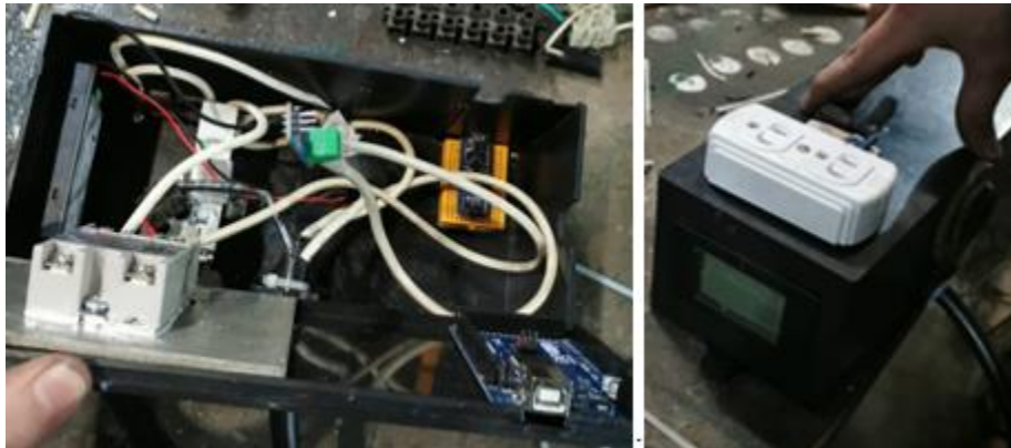
Figura 16. Caja de control usada en el reactor pirolizador. Fuente [Autores]
