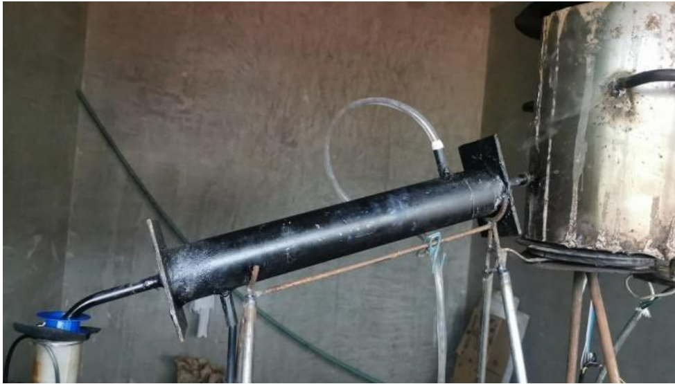
Figura 14. Condensador concéntrico usado en el reactor pirolizador. Fuente [Autores]
