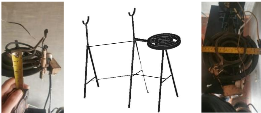
Figura 12. Estructura del equipo pirolizador. Fuente [Autores]
