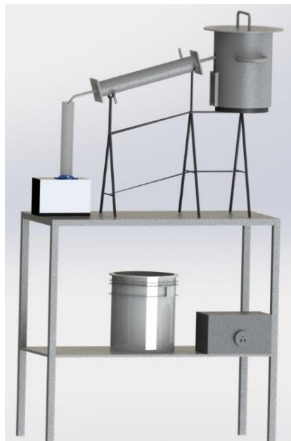
Figura 10. CAD del equipo pirolizador usado. Fuente [Autores]
