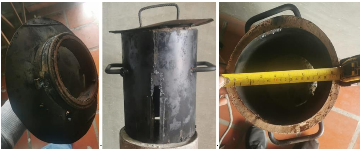
Figura 13. Horno aislante usado en el reactor pirolizador. Fuente [Autores]
