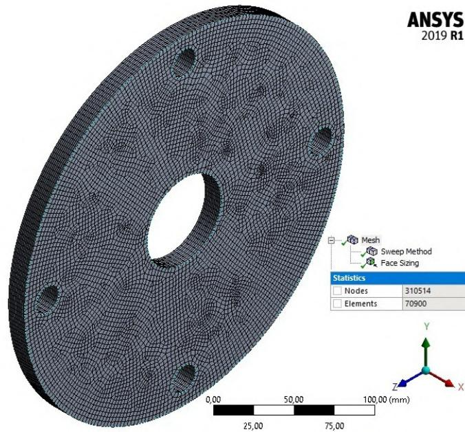
Figura 4-50: Malla aplicada en el rotor del mecanismo. Fuente: Autor.
