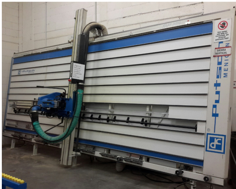
Ilustración 3. Sierra Vertical Referencia Putschini. Fotografía de Juliza Rodríguez (Cundinamarca,2015).
