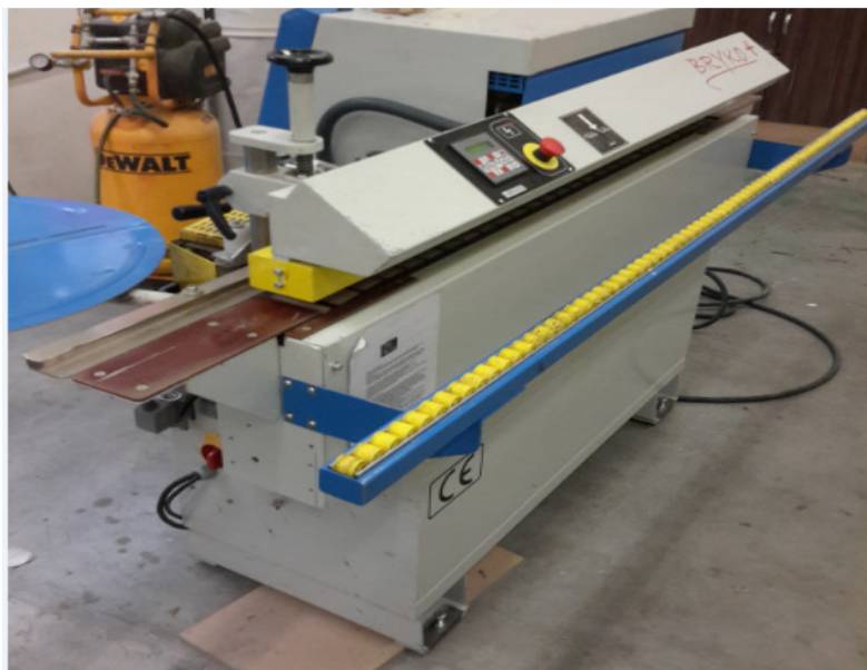
Ilustración 4 .Enchapadora Referencia BRYKO plus. Fotografía de Juliza Rodríguez (Cundinamarca,2015).
