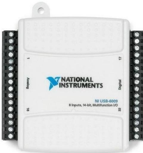
La USB DAQ 6009 consta de 8 canales de entrada analógica enumerados de 0 a 7: para un solo extremo mediciones, cada señal es una entrada analógica de voltaje. Para medidas diferenciales, también consta de entradas analógicas AI 0 y AI 4 son las entradas positivas y negativas del canal 0 de entrada analógica diferencial. Los siguientes pares de señales también forman una entrada diferencial. canales: AI <1, 5>, AI <2, 6> y AI <3, 7>.
