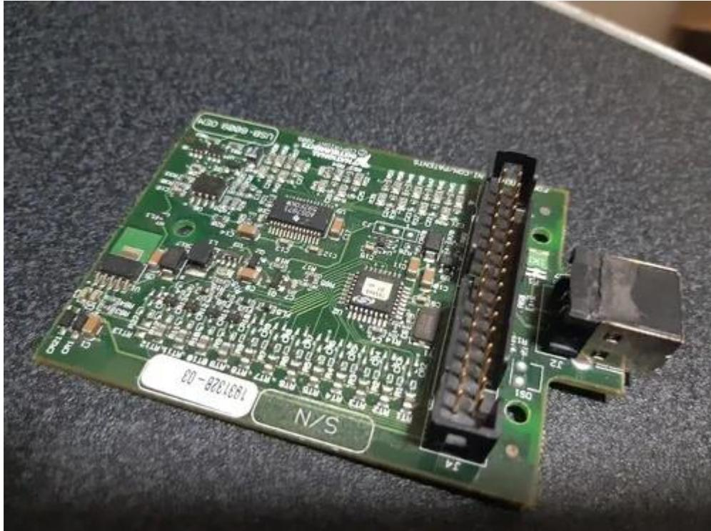
**Figura 20. Dispositivo USB de E/S Multifunción de National Instruments**
