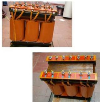
**Figura 49. Transformador trifásico**
