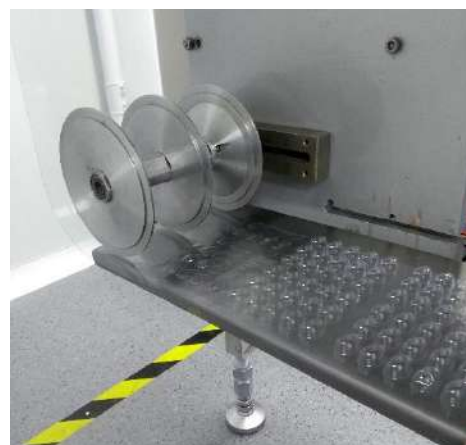
Figura. (7.4) 29: Discos curva de reenvío.
