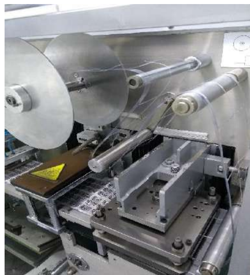
Figura. (7.4) 40: Ajuste transversal aflojando tornillos de fijación cara superior troquel.
