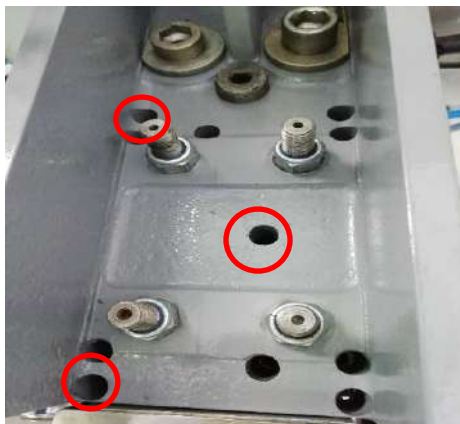
Figura. (7.3) 7: Ubicación tornillos de fijación placa sellado superior.
