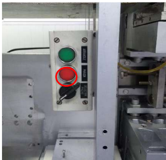
Figura. (7.3) 1: Pulsador rojo detención máquina para cambio de material de sellado.
