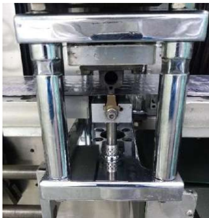
Figura. (7.4) 15: Estación de codificado.
