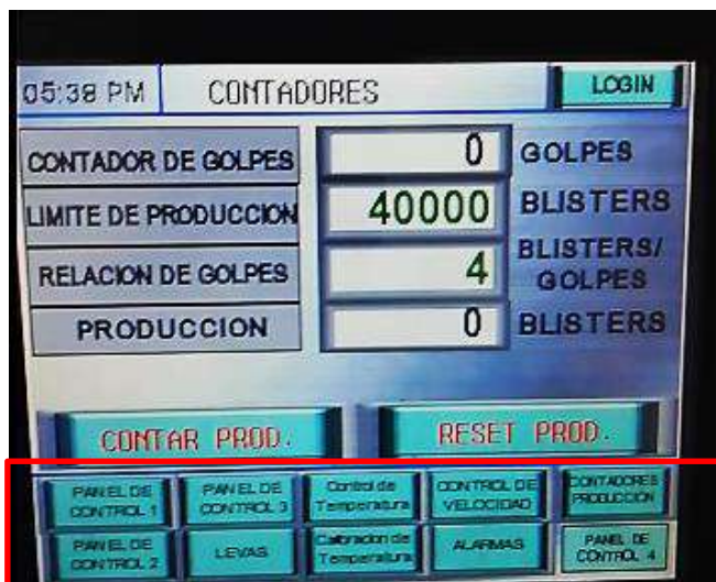
Figura. (7.12) 2: Accesos para modificación de parámetros.
