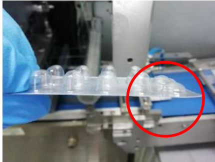
Figura. (7.4) 24: Alveolos mal formados.
