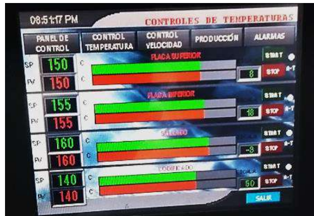
Figura. (7.4) 27: Sección del panel de control para el ajuste de temperaturas de las placas.
