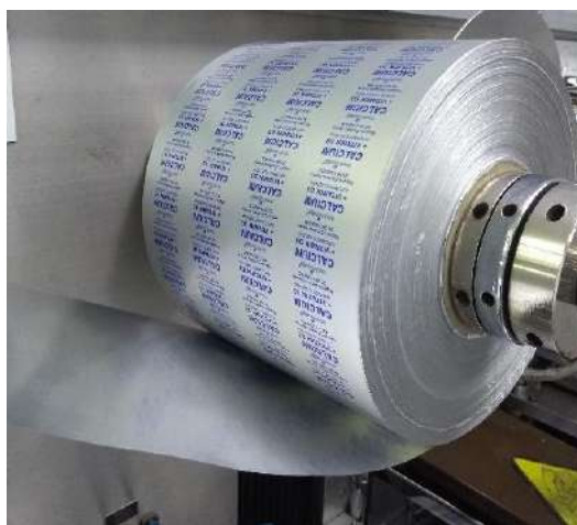
Figura. (7.3) 3: Dirección arte impreso en material de sellado.
