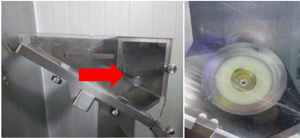
Figura. (7.7) 4: Ubicación rodillo de alimentación.
