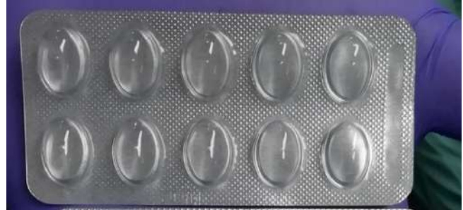
Figura. (7.4) 25: Alveolos con el formado adecuado.
