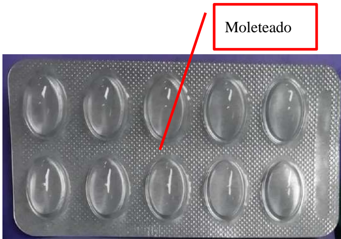
Figura. (7.3) 44: Moletado uniforme en todo el blíster.
