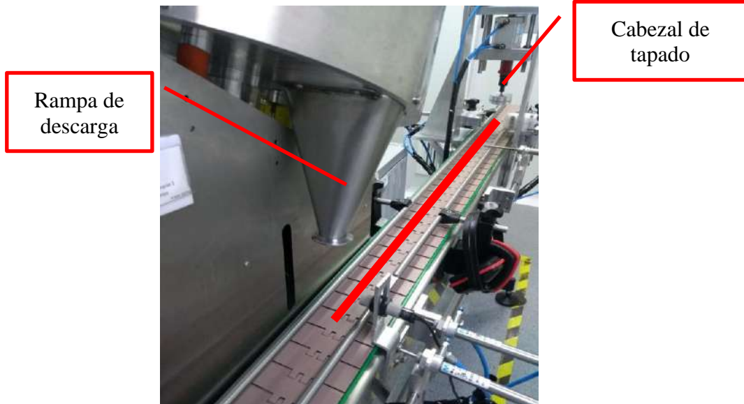
Figura (7.2) 3: Indicación recorrido de los frascos.
