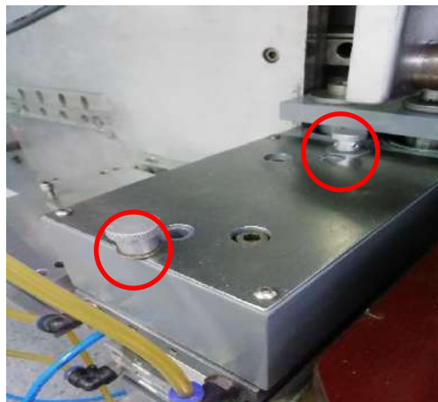
Figura. (7.3) 5: Tuercas de fijación
