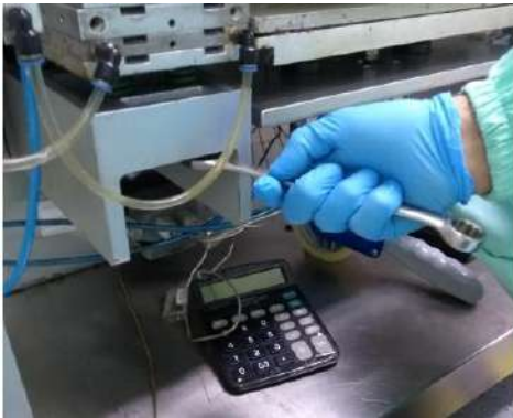
Figura. (7.4) 26: Ajuste altura estación de formado.
