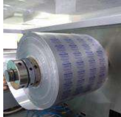
Figura. (7.4) 31: Disposición correcta material de sellado.
