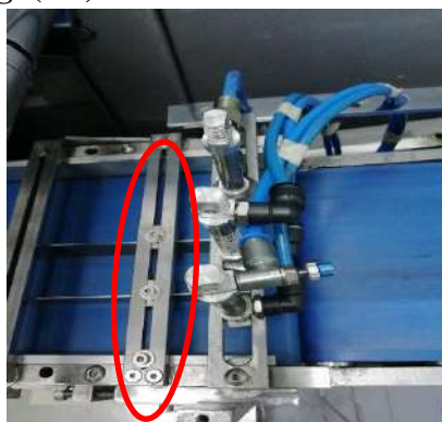
Figura. (7.3) 14: Tornillos para ajuste de sistema de guías (parte delantera).
