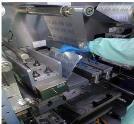
Figura. (7.4) 22: Prueba inicio de sellado.
