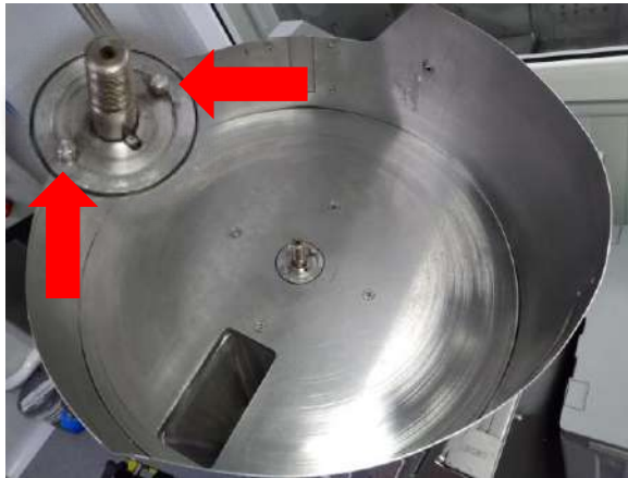
Figura (7.2) 1: Pines de posicionamiento.
