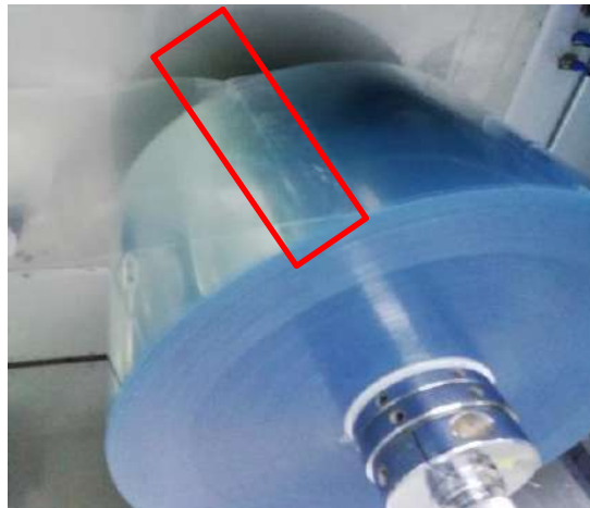
Figura. (7.2) 4: Empalme material de formado.
