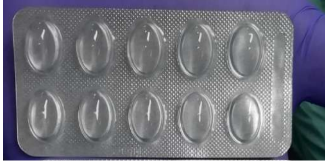
Figura. (7.3) 28: Alveolos con formación adecuada.
