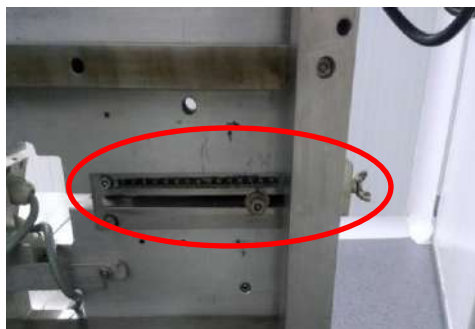
Figura. (7.3) 31: Perilla ajuste curva de reenvío.
