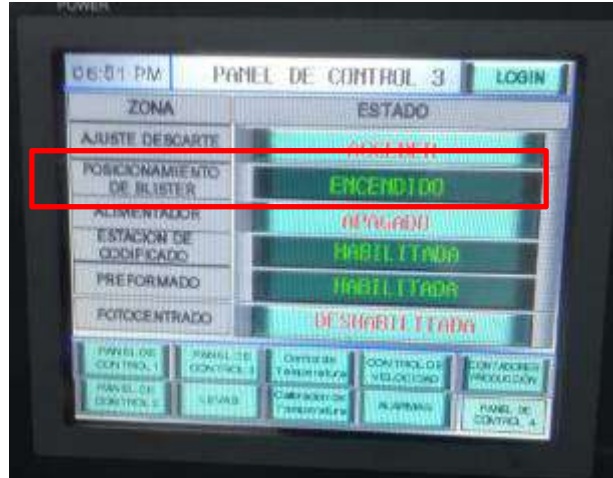
Figura. (7.3) 48: Habilitación del sistema de posicionamiento de blíster en panel de control.
