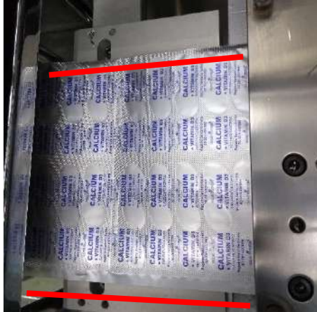
Figura. (7.4) 30: Material de sellado centro en el PVC.
