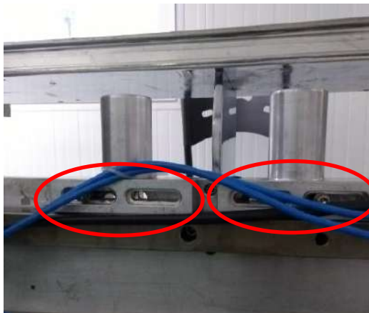
Figura. (7.7) 13: Correderas soportes sistema alimentaci n dedicado.
