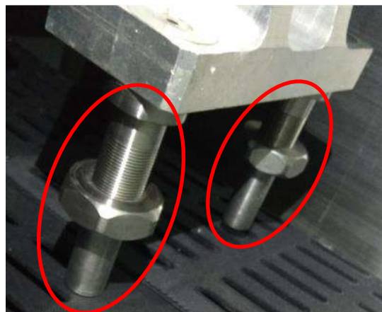
Figura. (7.7) 2: Pines sistema de alimentación dedicado.
