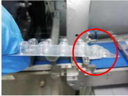
Figura. (7.3) 27: Alveolos mal formados.
