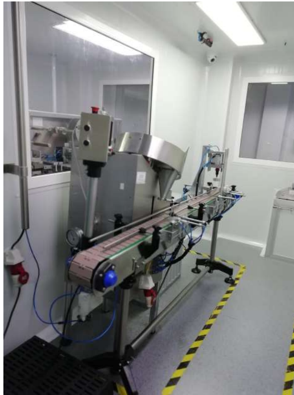
Figura 4.3.1: Envasadora de frascos EEP-003-PD.
