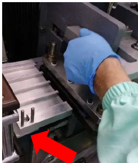
Figura. (7.3) 43: Guía a la salida de codificado, opción de ajuste corte transversal en estación de corte.
