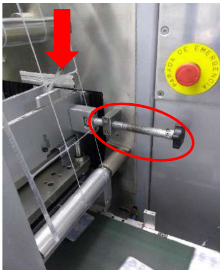
Figura. (7.4) 35: Escala graduada y tornillo sin fin estación de corte.
