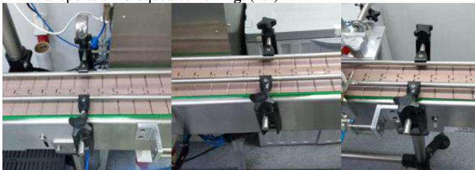
Figura (7.2) 4: Perillas de fijación de guías de recorrido.
