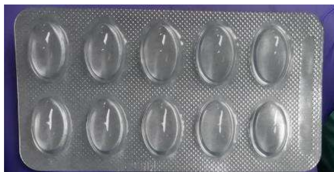
Figura. (7.4) 38: Blíster centrado transversalmente.
