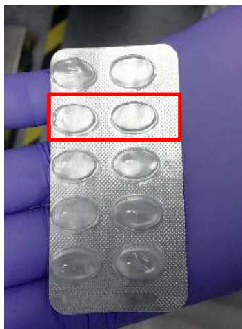
Figura. (7.3) 40: Blíster desviado transversalmente.
