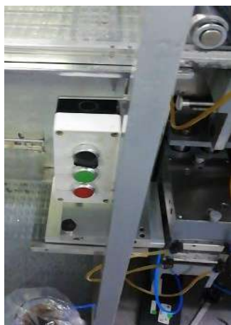
Figura. (7.3) 18: Caja de control
