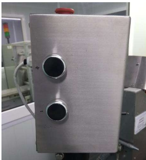
Figura. (7.3) 10: Selectores control de velocidad de la ENVASADORA DE FRASCOS EEP-003-PD.
