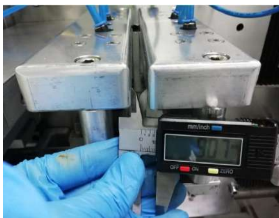
Figura. (7.4) 17: Pinzas de avance en punto 0.
