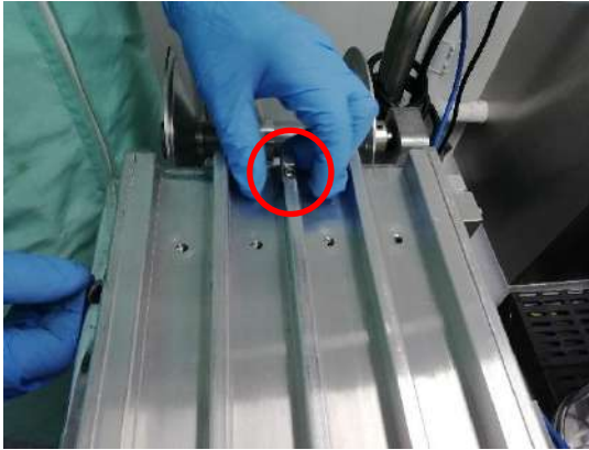
Figura. (7.4) 2: Tornillo de fijación M6 1 (guía de alimentación).
