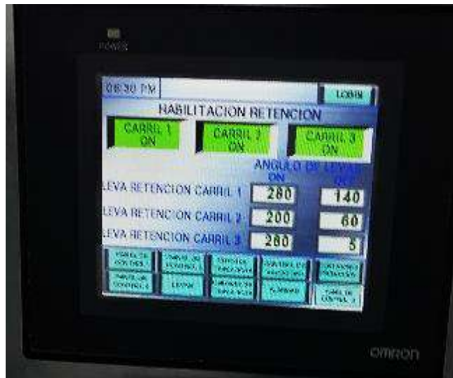
Figura. (7.3) 47: Habilitación de carriles en panel de control.
