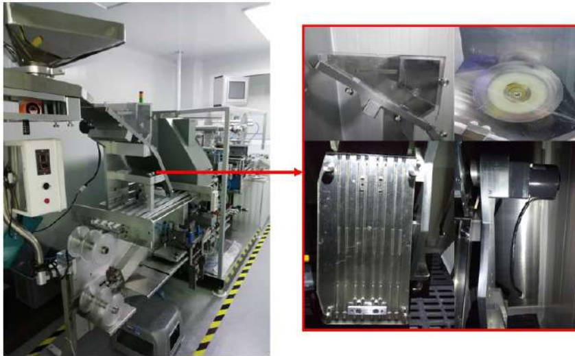
Figura 4.2.16: Estación de alimentación (Alimentador dedicado).
