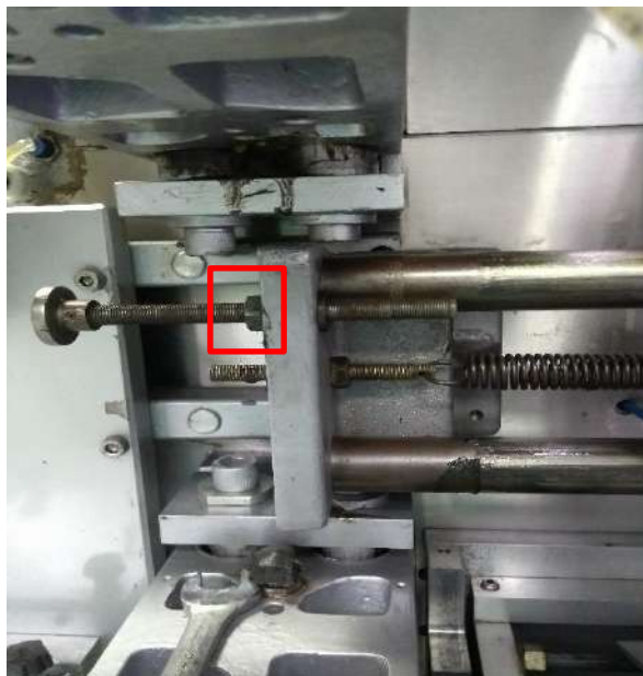
Figura. (7.4) 20: Tuerca tornillo sin fin ajuste paso fino.
