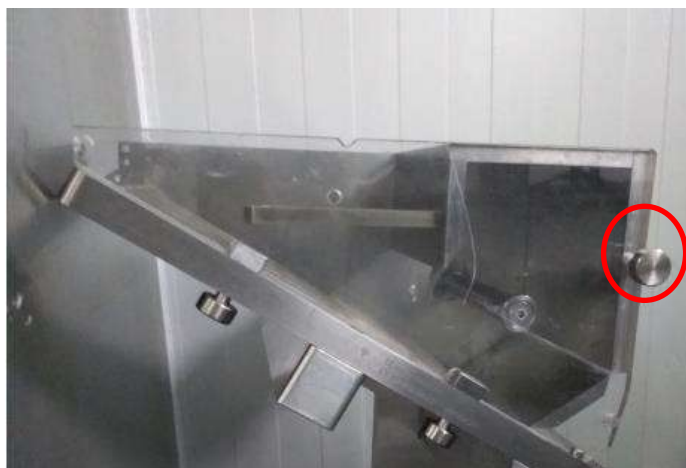
Figura. (7.7) 3: Tuerca de sujeción placa de acrílico de la caja de alimentación.
