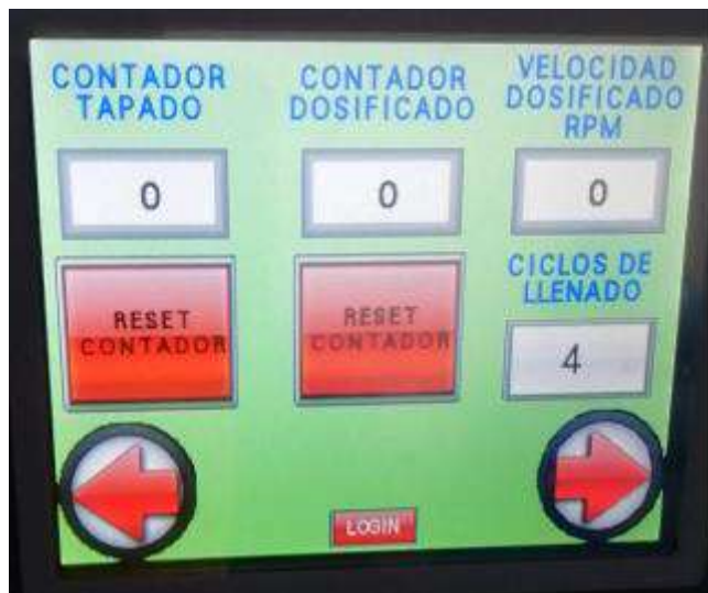
Figura. (7.3) 7: Menú visualizador de variables.
