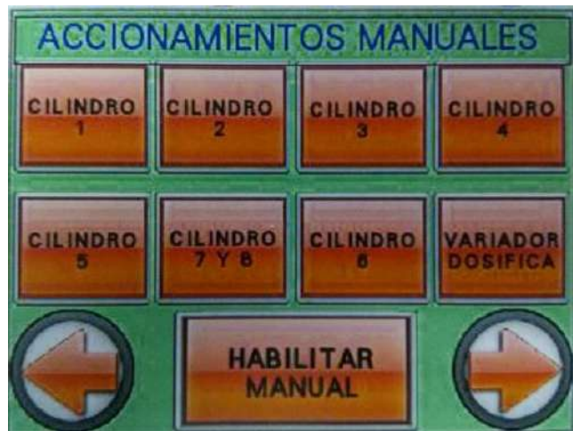
Figura. (7.3) 8: Menú accionamiento manual.
