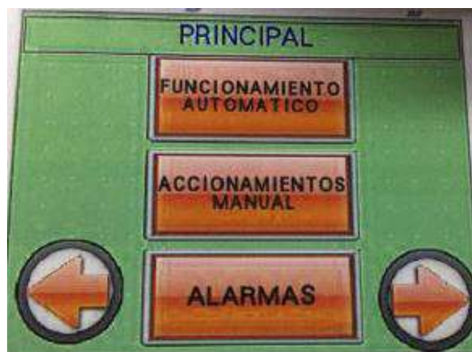
Figura. (7.3) 3: Menú principal panel de control envasadora de frascos.
