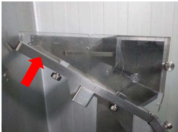
Figura. (7.7) 8: Placa alimentadora.
