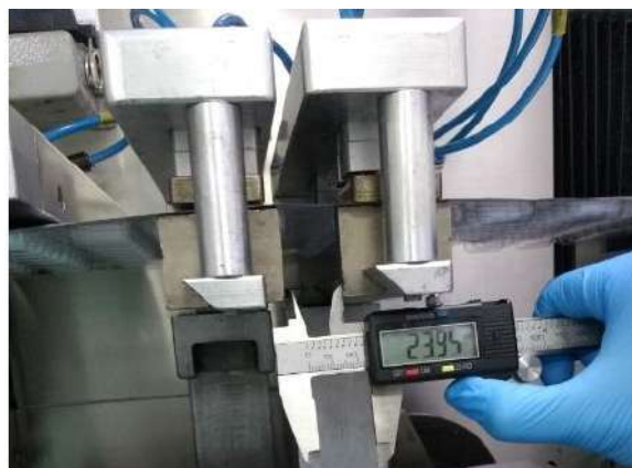
Figura. (7.3) 19: Pinzas de avance en punto cero.
