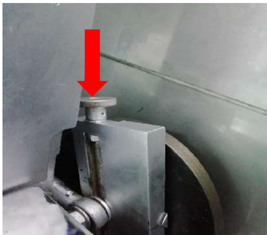
Figura. (7.3) 21: Tuerca de seguridad tornillo sin fin ajuste paso grueso.
