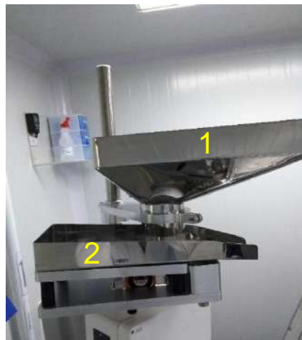
Figura. (7.7) 19: “Tolva y bandeja de alimentación” estación de alimentación.
