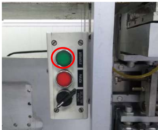
Figura. (7.2) 5: Pulsador verde caja de control.
