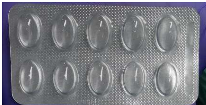
Figura. (7.3) 41: Blíster centrado transversalmente.
