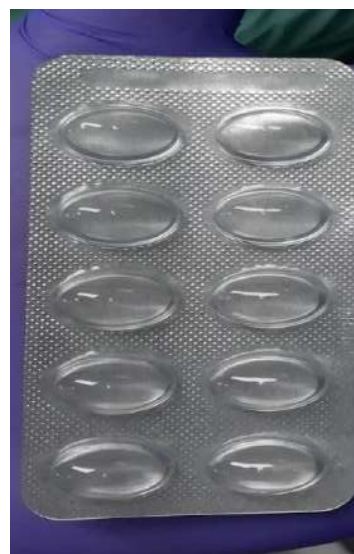
Figura. (7.3) 37: Blíster centrado longitudinalmente.
