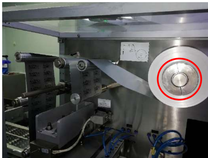
Figura. (7.3) 2: Tope centrado debobinado aluminio.
