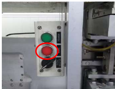
Figura. (7.2) 1: Pulsador rojo detención máquina para cambio de material de formado
