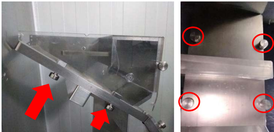
Figura. (7.7) 6: Ubicación Tuercas de sujeción caja de alimentación.
