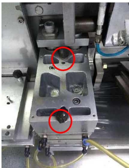
Figura. (7.4) 8: Tuercas de fijación (placa de formado).
