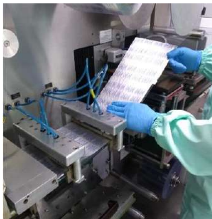
Figura. (7.3) 25: Prueba hasta inicio de sellado.
