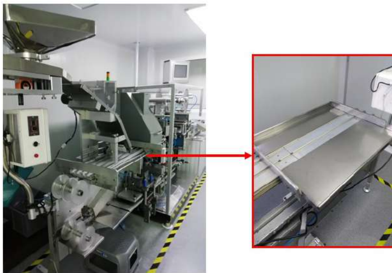
Figura 4.2.15: Estación de alimentación (Bandeja universal).
