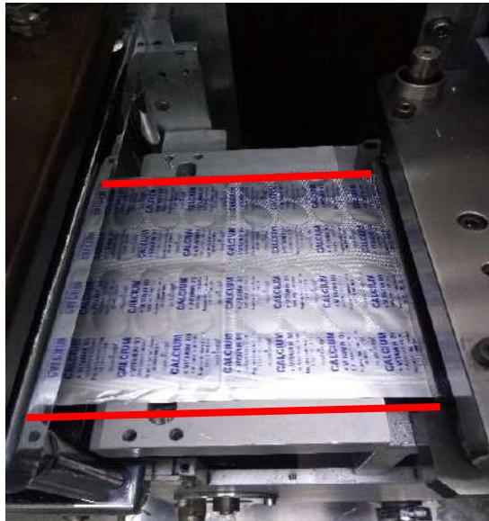
Figura. (7.3) 6: Material de sellado centrado en el PVC.
