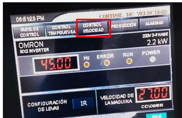
Figura. (7.10) 8: Control de velocidad de la blistera # 2 y ajuste valores de levas.
