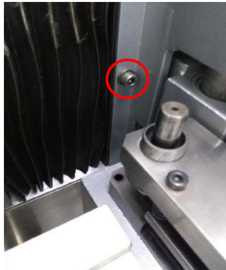
Figura. (7.4) 36: Tornillo para aflojar estación de corte y hacer ajuste longitudinal.
