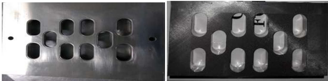
(a) Placa de formado estación ALU-ALU.
