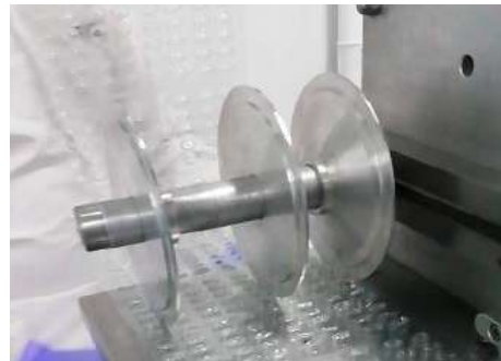
Figura. (7.3) 32: Discos curva de reenvío.
