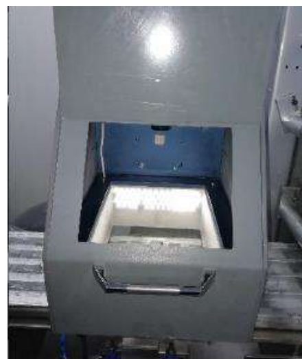
Figura. (7.11) 7: Cámara de visión
