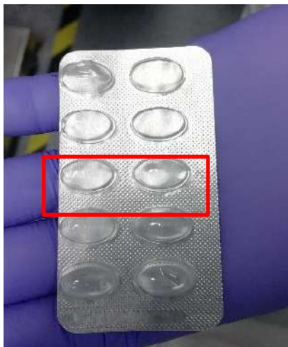
Figura. (7.4) 37: Blíster desviado transversalmente.
