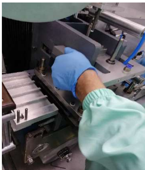
Figura. (7.3) 42: Ajuste transversal troquel de corte aflojando tornillos de fijación cara superior del troquel.
