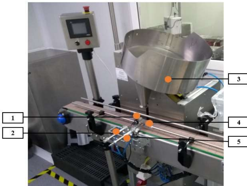
Figura 4.3.5: Estación de llenado de frascos.
