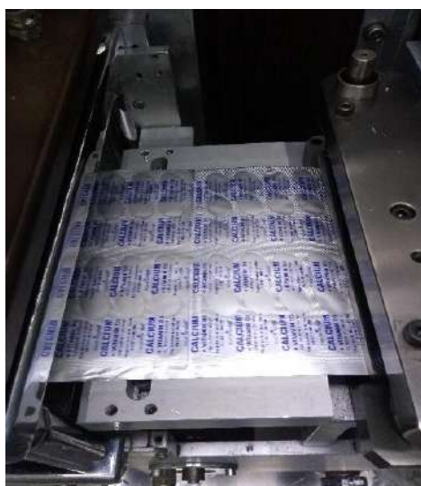
Figura. (7.4) 39: Guía a la salida de codificado, opción de ajuste corte transversal en estación de corte.
