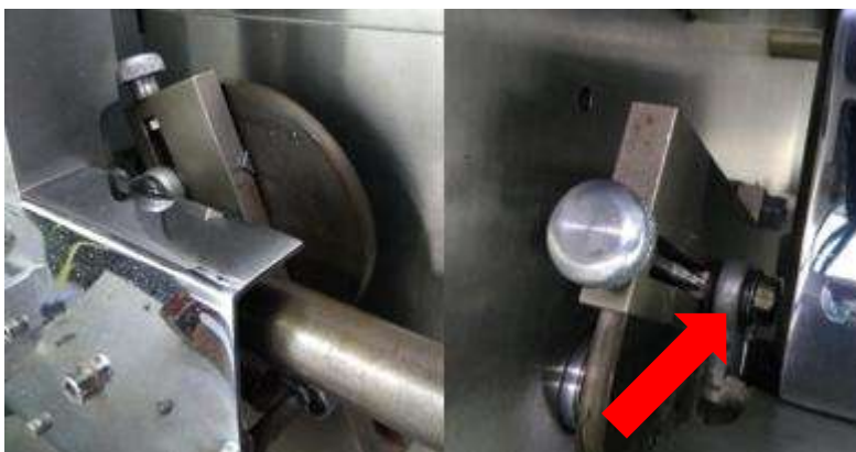
Figura. (7.4) 19: Tuerca tornillo sin fin ajuste paso grueso.
