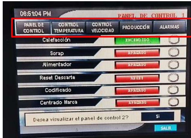
Figura. (7.10) 2: Accesos para modificación de parámetros en la blistera # 2.
