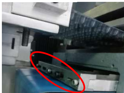
Figura. (7.3) 16: Tornillos para remover o ajustar sistema de guías (parte trasera).
