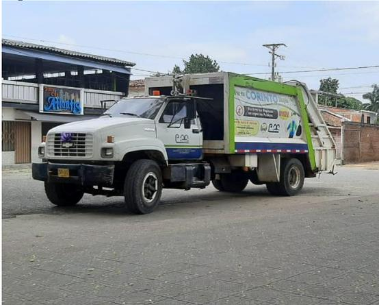
El camión compactador es de marca Chevrolet, de la línea KODIAK modelo 2009 (figura 13). Por inspección visual se puede denotar las malas condiciones en las que este se encuentra, sumado a esto, la semana de inspección y reconocimiento se evidenció detención de las labores de este equipo debido a un escape de aceite hidráulico por una de las líneas, perdiendo presión en uno de los brazos hidráulicos.
