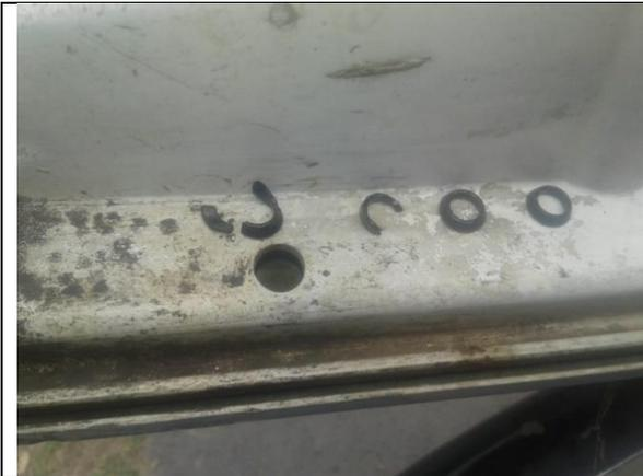
Repuestos para mantenimiento de inyectores
