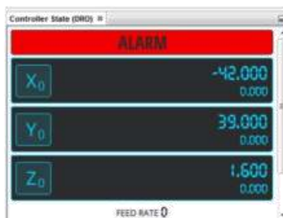
Figura 61 Ubicación de los ejes y señal de alarma [Autor].
