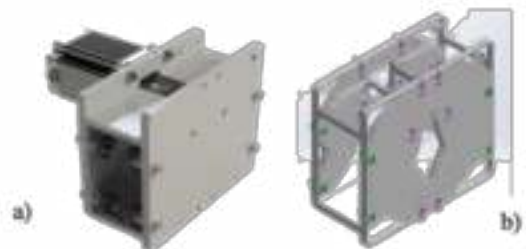
Figura 6. Geometrías: (a) Pieza sin análisis topológico. (b) Pieza con el análisis topológico. Fuente: Los autores.
