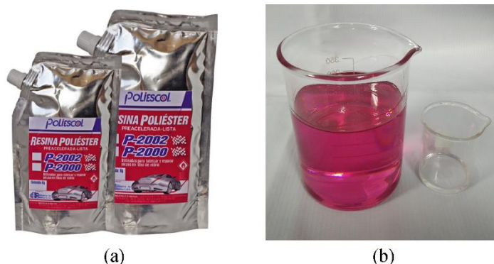
Figura 5. Resina poliéster P-2002: (a) Presentación. (b) Aspecto de la resina y el catalizador.
