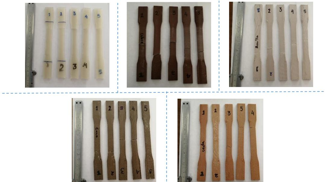
**Figura 48.** Probetas después del ensayo de tracción[Autor]
