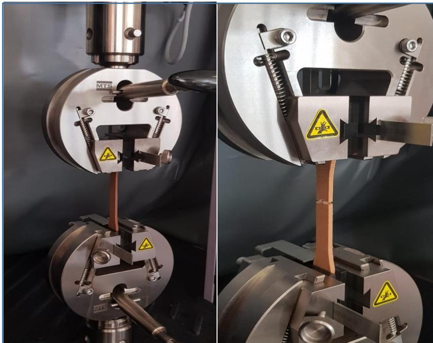
**Figura 39.** Montaje Ensayo de Tracción[Autor]
