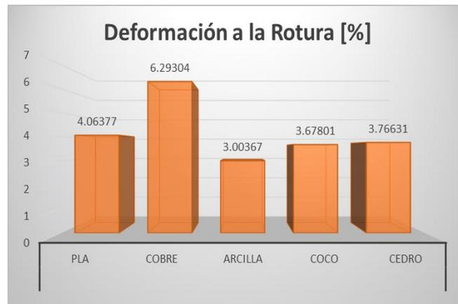
**Figura 77.** Análisis comparativo de la deformación a la rotura [Autor]
