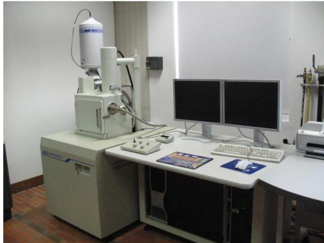
**Figura 43.** Microscopio Electrónico de Barrido JEOL JSM-6490LV[36]
