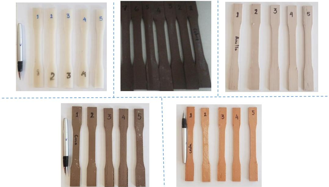
**Figura 47.** Probetas antes del ensayo de tracción[Autor]
