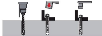
Figura 70. Características anclaje de expansión (INDEX, 2019).
