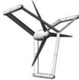
Figura 6. Turbina Gesmey “Generador Eléctrico Submarino con Estructura en Y”(Otamendi, 2018).
