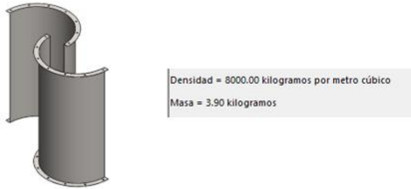
Figura 23. CAD álabes del rotor y su respectiva masa. (elaboración propia)
