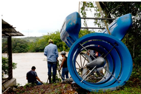
Figura 13. Turbina Smart Hydro Power (Contreras, 2018).
