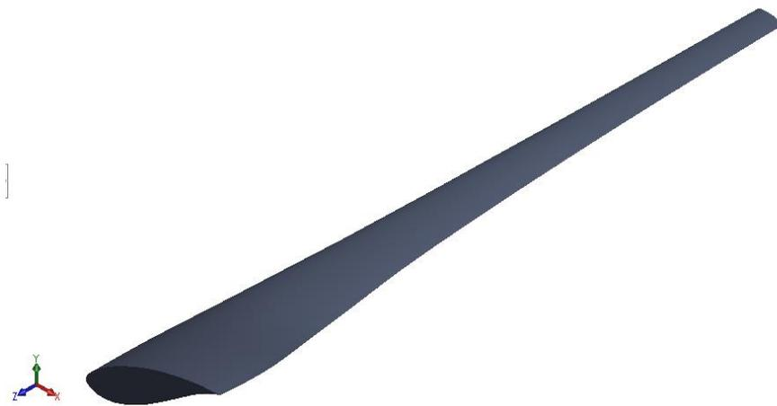
Figura 32 Diseño 3D del álabe
