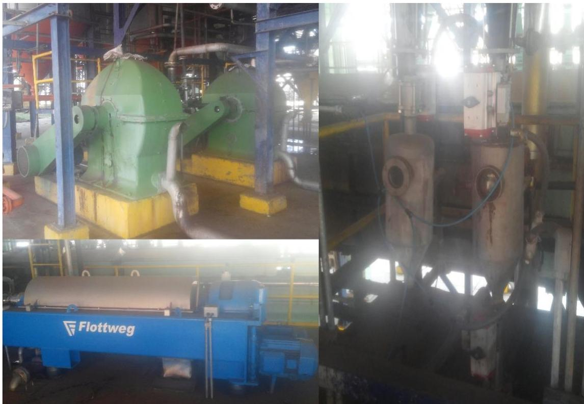
Figura 11. Centrifugas (arriba), Tricanter (abajo), Desarenadores (derecha). *Fuente: autor*
