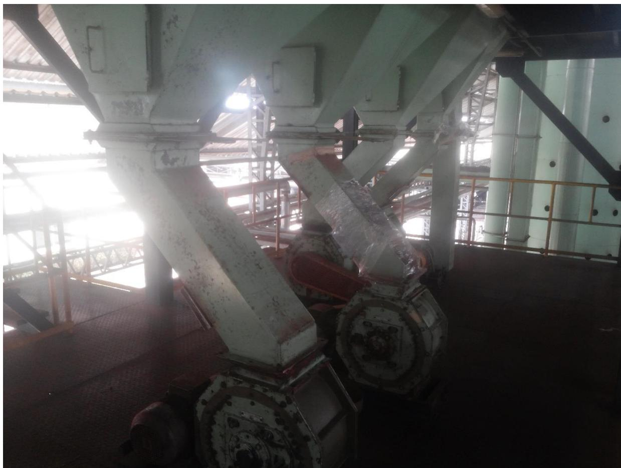
Figura 14. “Ripple mill”. *Fuente: autor*
