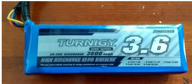
Figura 39. Bateria lipo 3s 3600mAh Elaboración propia.
