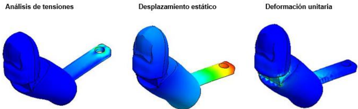
Figura 60. Estudio de análisis estático, antebrazo inferior. Elaboración propia. Solid Works®.
