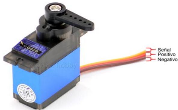
Figura 42. Micro servomotor MG92B. Elaboración propia.
