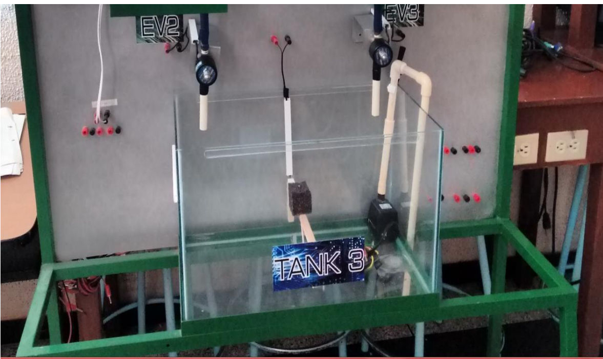
Llenado de tanque 3 TANK 3, y Activacion de motobomba
