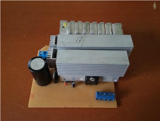
Figura 45. Etapa de Potencia. Vista Superior.
