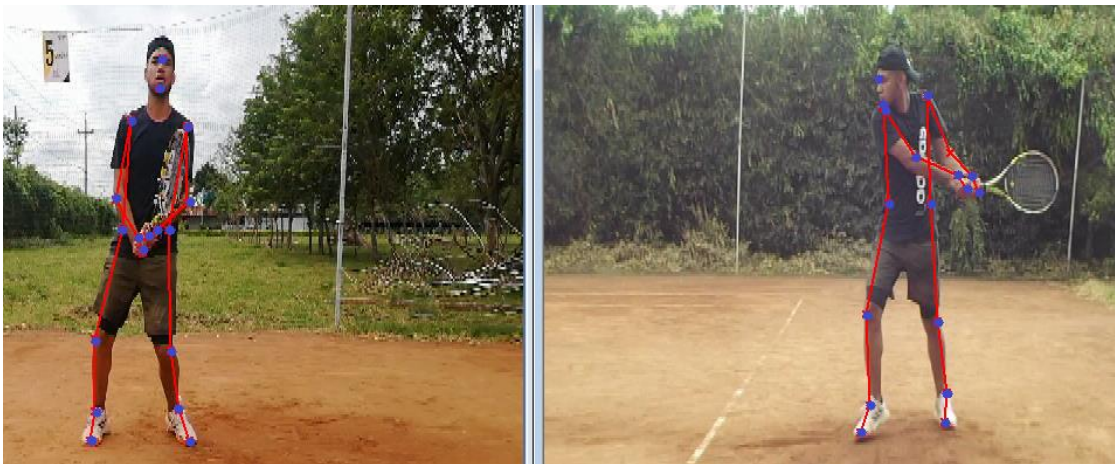
Figura 6. Puntos de referencia (pies, tobillos, rodillas, caderas, hombros, codos, muñecas, dedos de la mano, mentón y frente), siendo 18 puntos en total.
