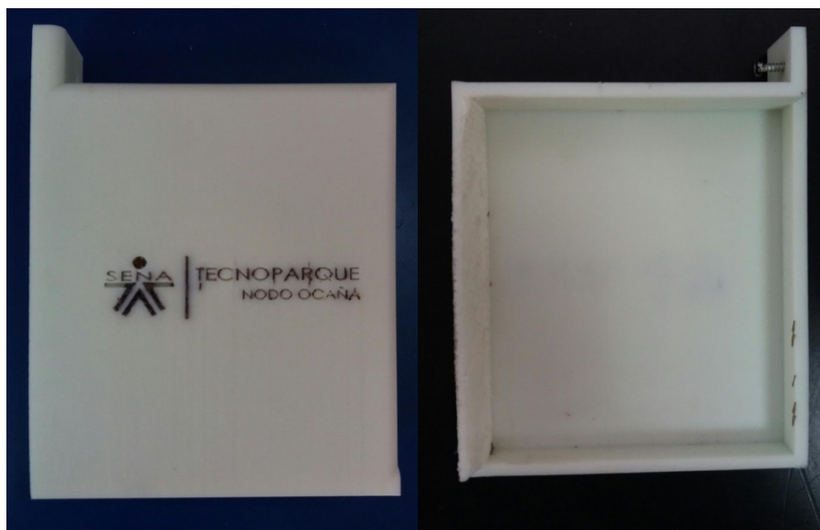
Figura 39. Estructura para el circuito de control. Fuente: Autor.
