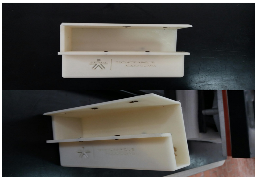
Figura 40. Estructura para proteger el motor encargado de la apertura de la puerta principal. Autor: Fuente.
