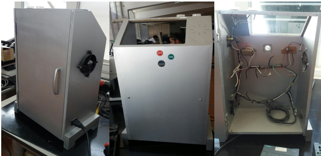
Figura 82. Caja en MDF que va a contener la circuitería del sistema de gestión de energía. Fuente: Autor.
