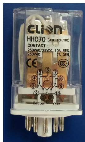
Figura 68. Relevador de potencia HHC70. Fuente: Autor.
