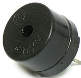
Figura 45. Zumbador utilizado en el sistema de alarma. Fuente: nextiafenix.com
