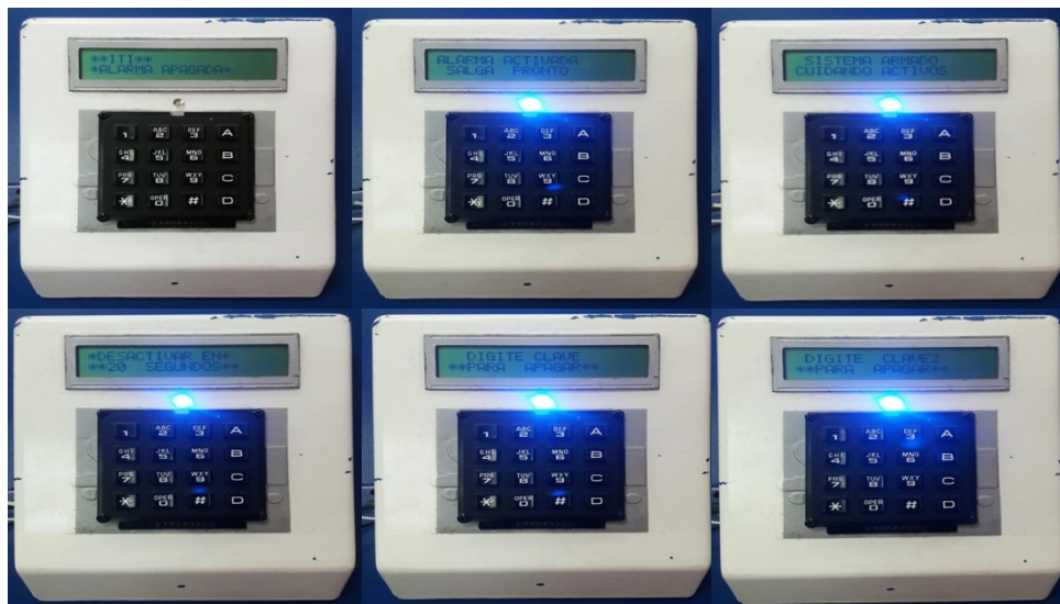
Figura 51. De izquierda a derecha y empezando en la fila de arriba; estado ‘0’ (indica la alarma apagada); estado ‘1’ (indica que la alarma ha sido activada); estado ‘1’ (indicando que ya paso el tiempo de 20 segundos para activar la alarma); estado ‘2’ (alarma en funcionamiento); estado ‘3’ (la alarma ha detectado un intruso); estado ‘4’ (envió de correo electrónico); estado ‘6’ (pin bloqueado). Fuente: Autor.
