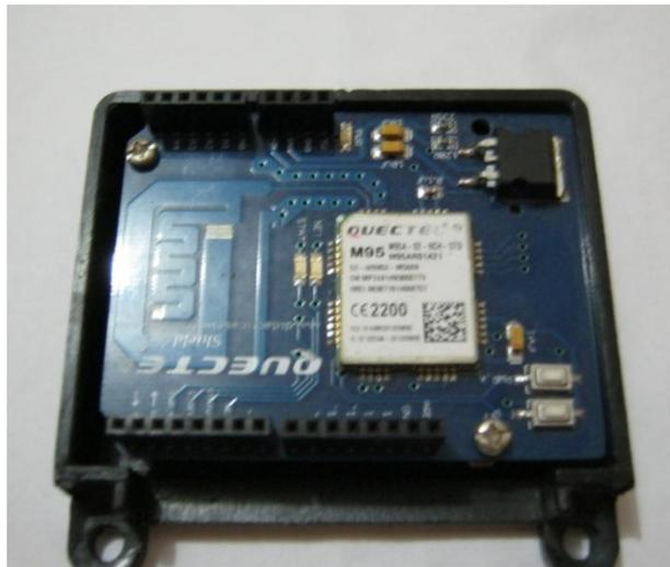
Figura 14. Modulo GSM/GPRS M95.
