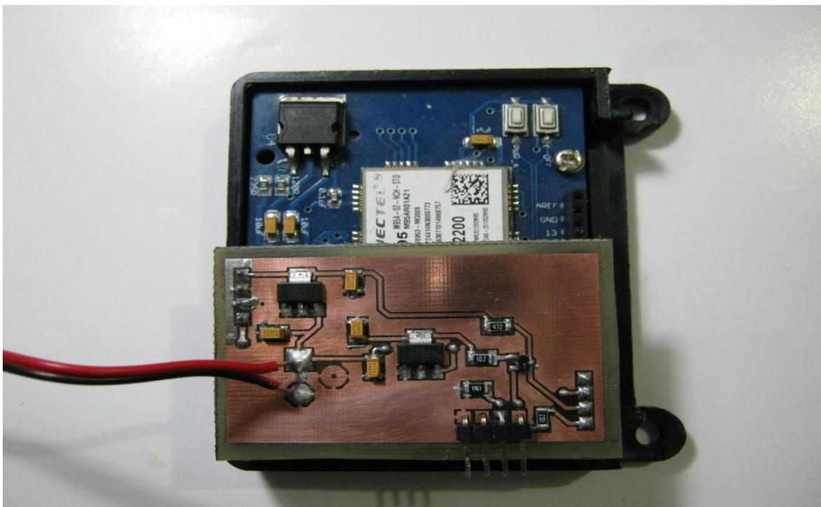
*Figura 20. Circuito impreso acoplado al modulo GSM.*
