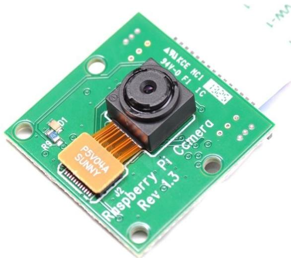
Figura 13. Modulo de cámara de la Raspberry pi - PiCamera.
