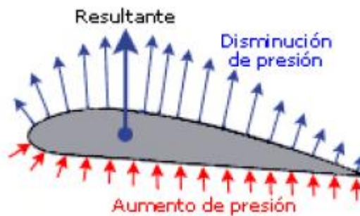
Figura 7. Distribuciones de presiones en un perfil alar. Fuente: (Fernandez, L., Molla, P., 2012).
