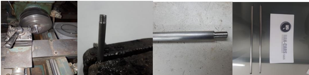
Figura 7-1. Fabricación de roscas a las columnas fijas. Fuente: Autor
