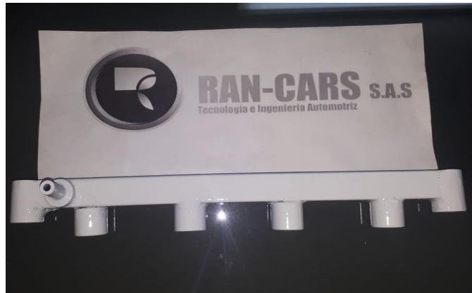
Figura 7.12: Riel de inyectores. Fuente: Autor
