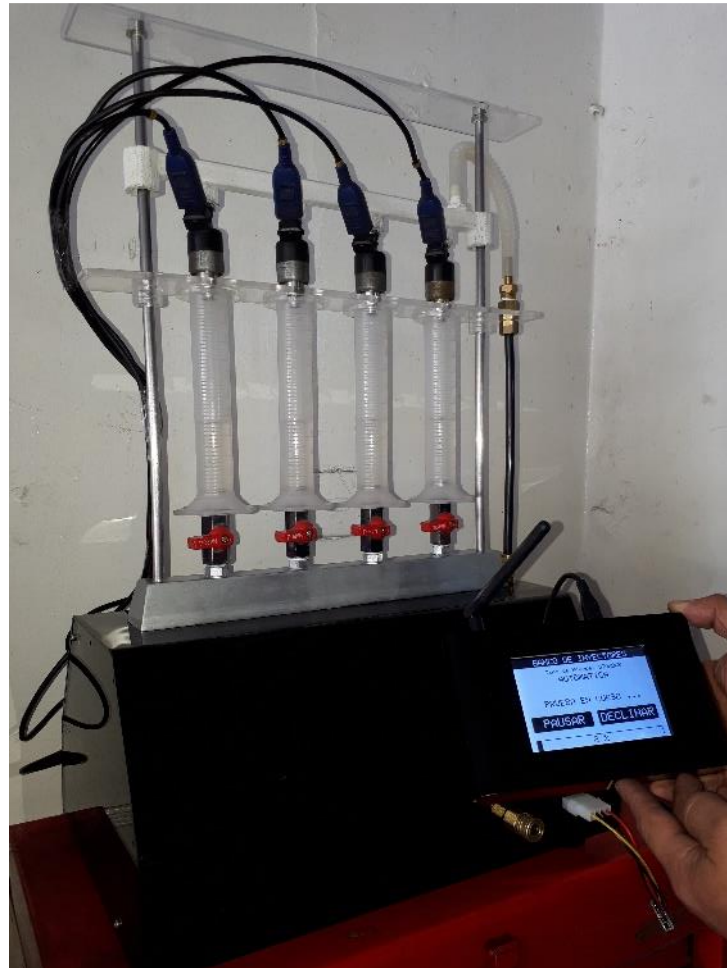
Figura 8.1. Banco de inyectores y Mando de control inalámbrico. Fuente: Autor
