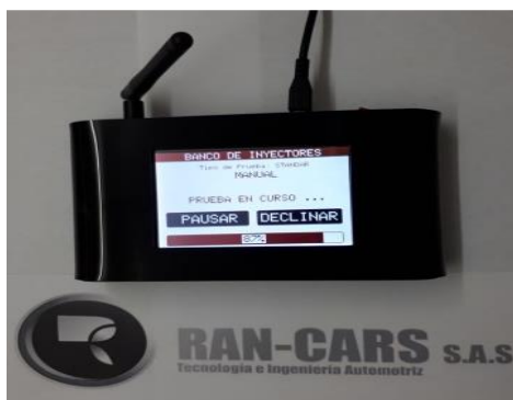
Figura 8.5 Se visualizan las opciones de pausar o declinar la prueba. Fuente: Autor
