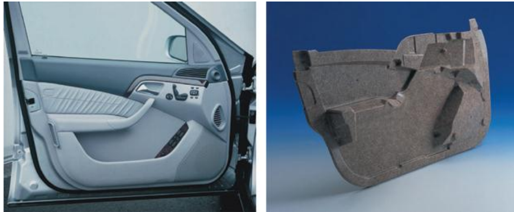
Figura 5. Puertas moldeadas con alfombras de 60% de fibra natural en una resina de poliuretano.
