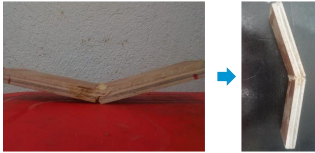
Figura 31. Probetas de material hibrido madera/fique-poliéster después de realizados los ensayos de flexión
