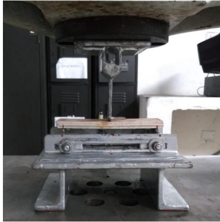
Figura 16. Montaje de la probeta para ensayo a flexión Fuente: Autor
