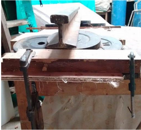
Figura 39. Montaje del material híbrido laminado en la prensa artesanal, moldeo por compresión
