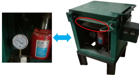
Figura 12. Montaje del material híbrido en la prensa hidráulica
