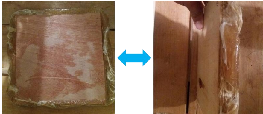
Figura 13. Material híbrido de 7 capas de (19 \times 19) \text{ cm}^2
