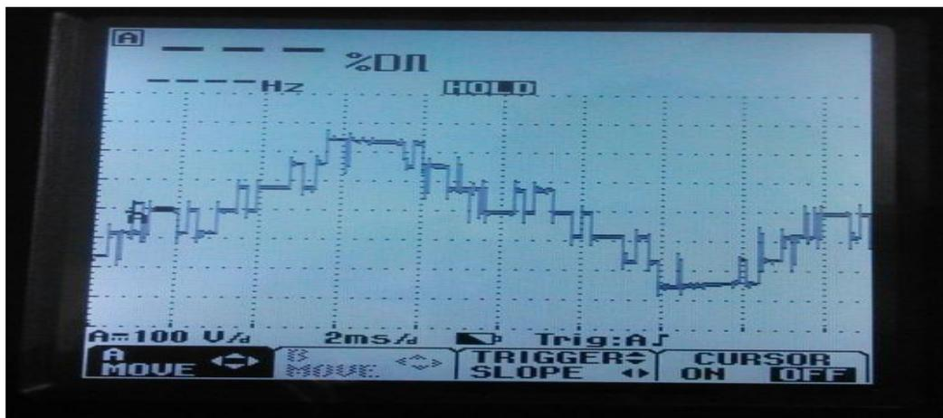
Figura 56. Voltaje de la Fase A del inversor con implementación de la eliminación selectiva de armónicos [24].
