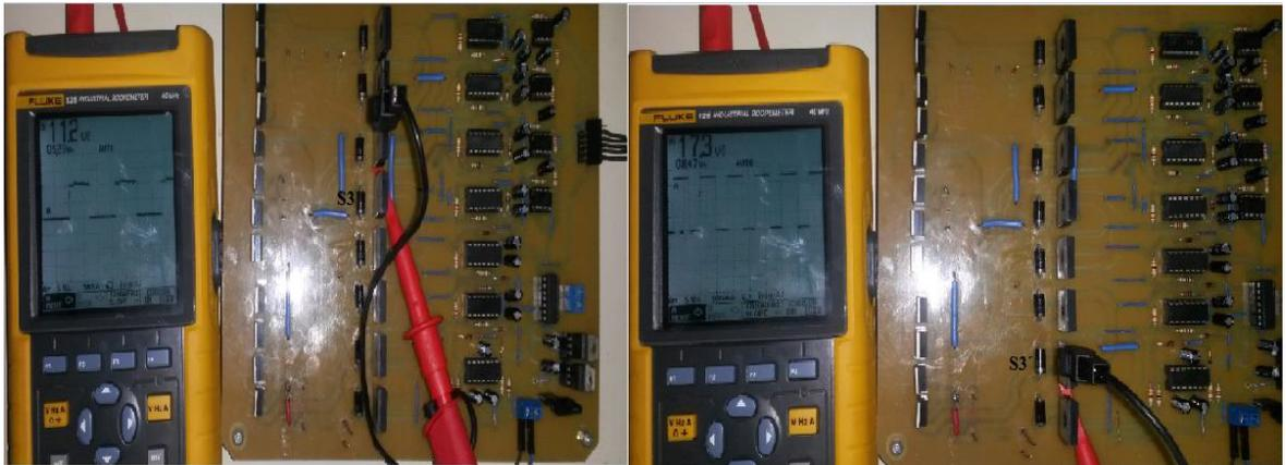
Figura 44. Señales de Control implementadas para S3 y S3'.
