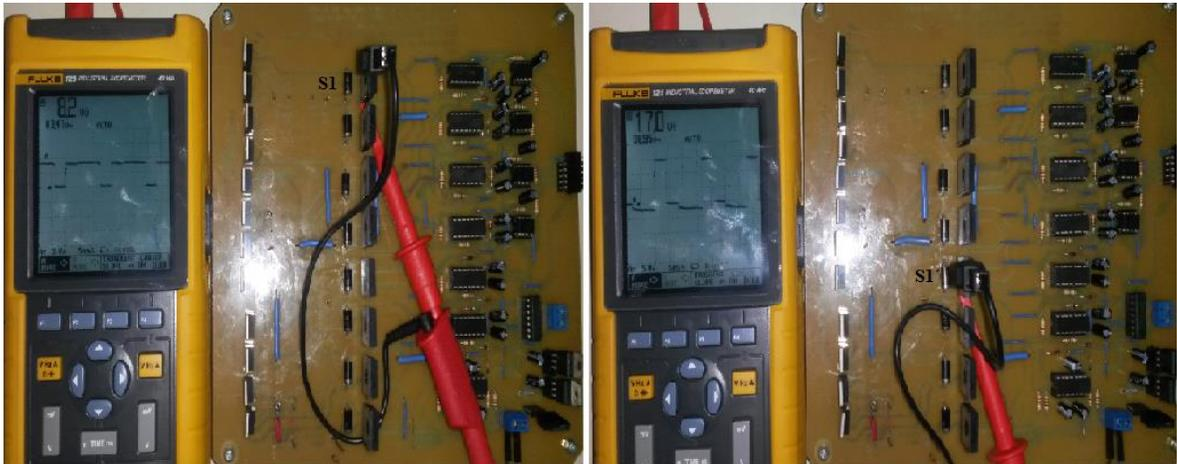
Figura 46. Señales de control implementadas para S1 y S1'.
