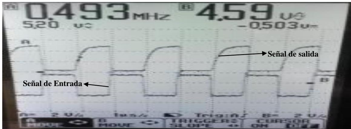
Figura 30. Señal de entrada y salida de optoacoplador 6N137.
