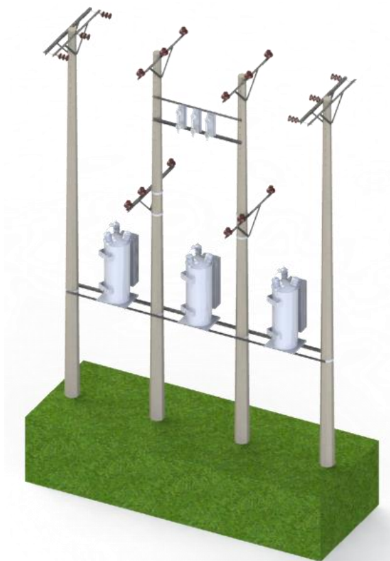
Anexo 1. Reguladores de media tensión (1)
