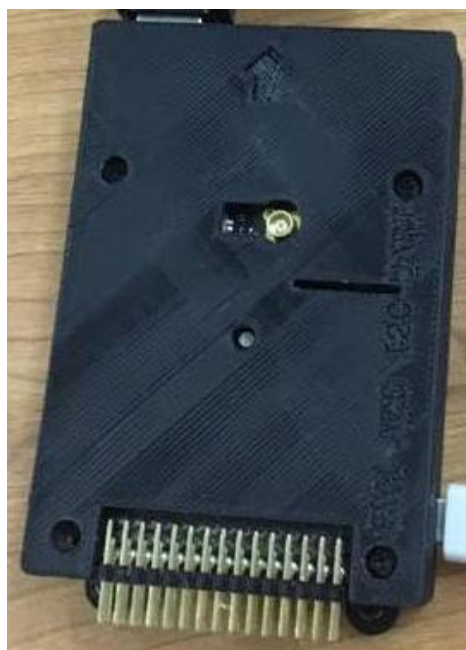
Figura 19. Carcasa impresa y ensamblada con las tarjetas. Fuente: Autor.
