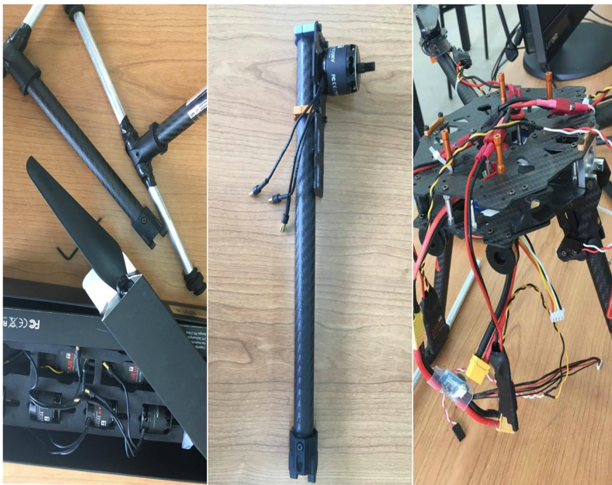
Figura 15. De izquierda a derecha: ensamble del soporte del dron; fijación de un motor en una de las extensiones del dron; el marco ensamblado al soporte y dos extensiones donde van los motores. Los cables de energía conectados y distribuidos por el marco. Fuente: Autor.
