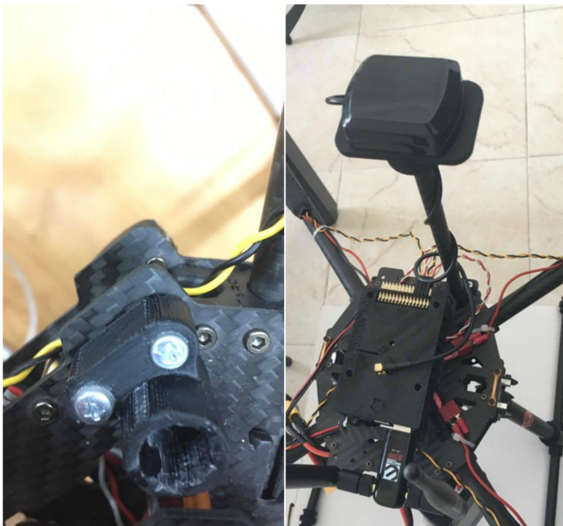
Figura 29. Ensamble de la torre de la antena GNSS (GPS) en el marco del dron. Fuente: Autor.
