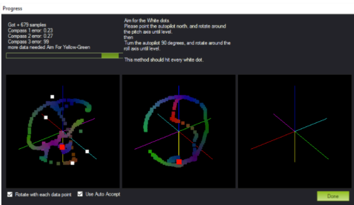
Figura 42. Calibración en vivo de las brújulas. Fuente: Autor.
