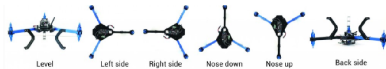
Figura 40. Rotaciones para calibrar el dron. De izquierda derecha, a nivel, lado izquierdo, lado derecho, nariz abajo, nariz arriba, reverso. Fuente: Ardupilot.
