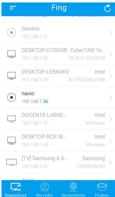
Figura 31. Dirección IP de la tarjeta Navio2 en la aplicación Fing. Fuente: Autor.
