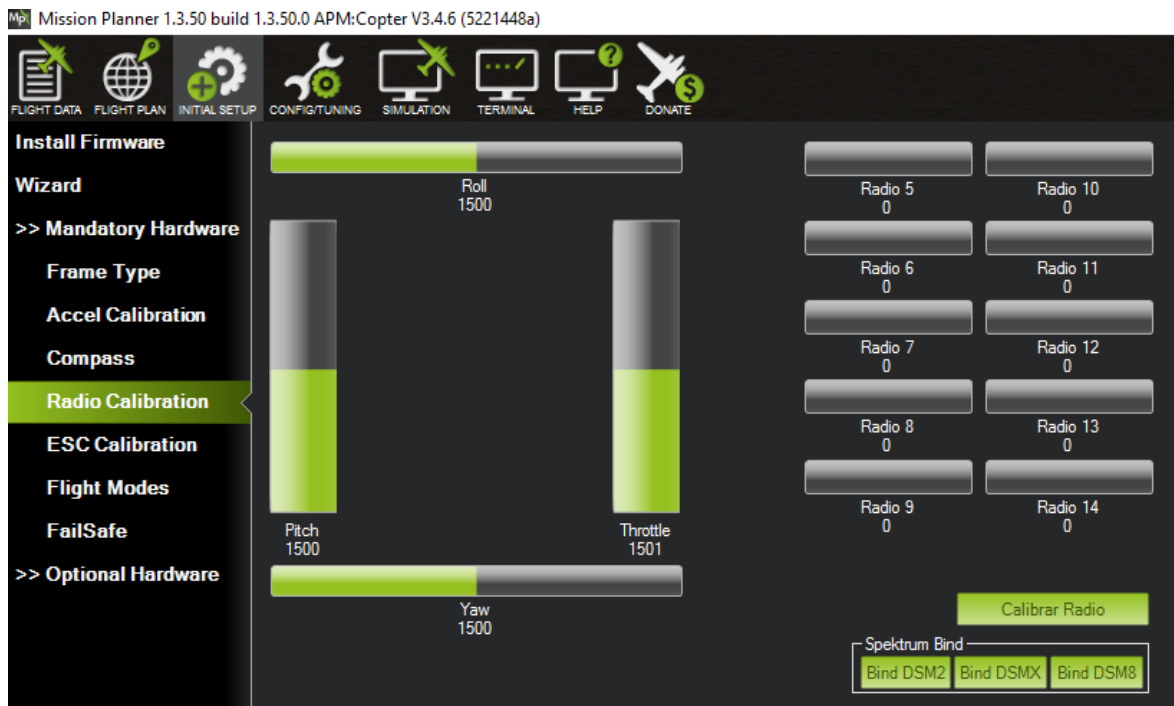
Figura 56. Calibración del mando USB como la radio control del dron. Fuente: Autor.
