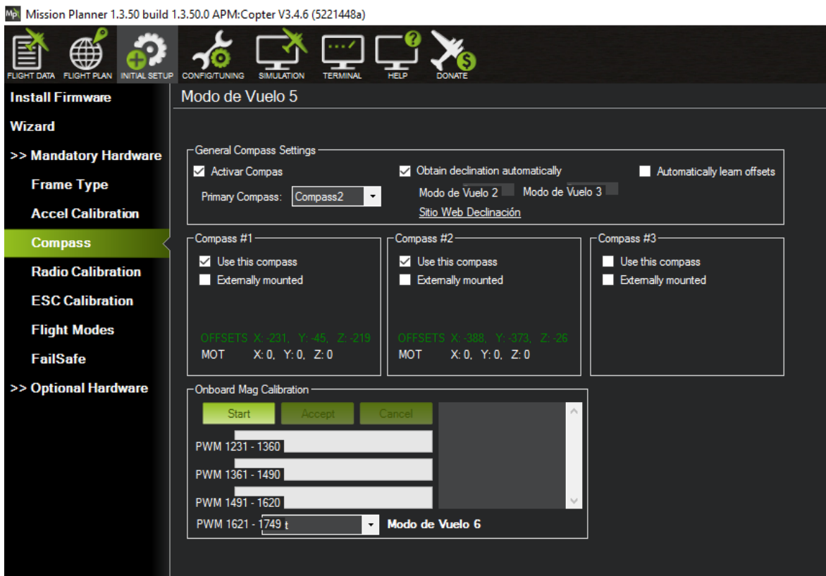
Figura 41. Calibración Onboard de las brújulas finalizada. Fuente: Autor.
