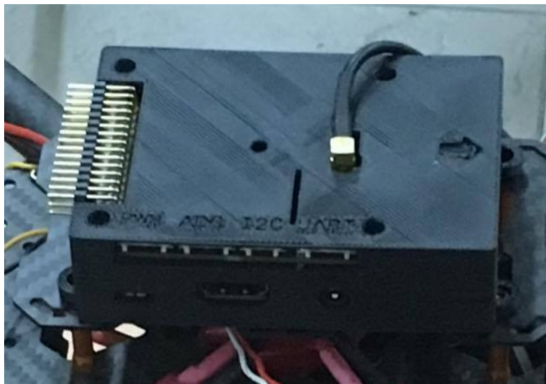
Figura 21. Carcasa fijada en la parte superior del marco del dron. Fuente: Autor.
