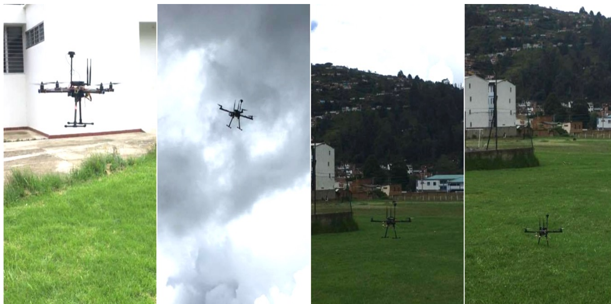
Figura 63. Vuelo del piloto automático. De izquierda a derecha: despegue; maniobras en el aire; preparándose para aterrizar; aterrizaje. Fuente: Autor.
