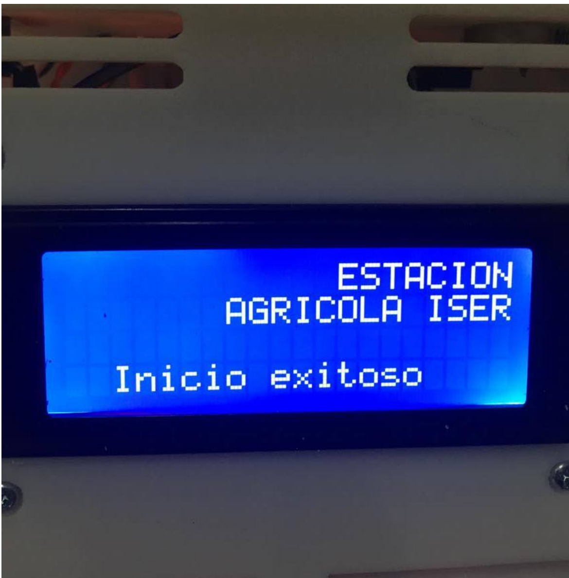
Figura 84. Inicio exitoso de la estación meteorológica. Significa que el módulo SD/micro SD está conectado y funciona, así como los puertos seriales y la LCD. Fuente: Autor.
