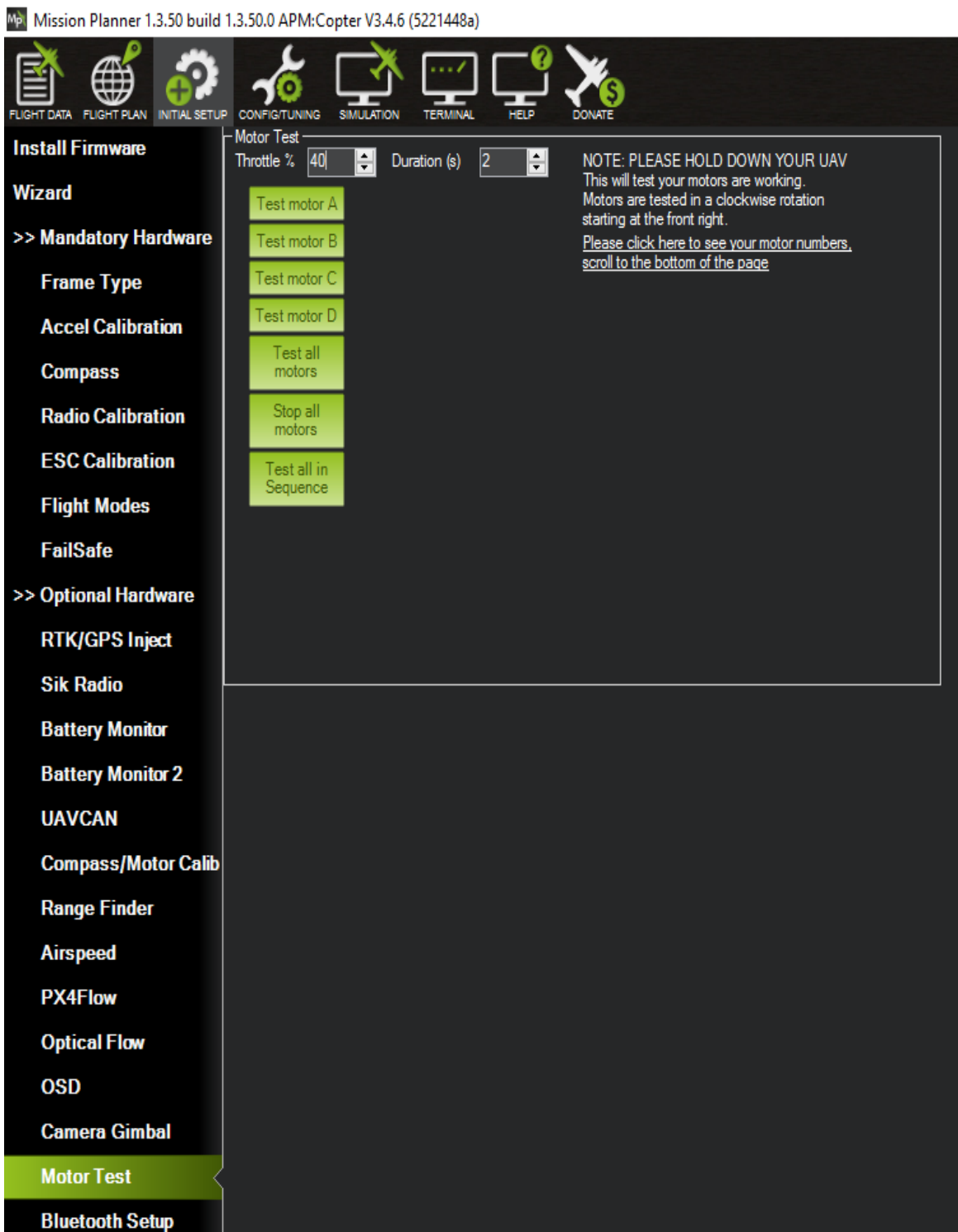
Figura 45. Prueba de movimiento de los motores en Mission Planner . Fuente: Autor.
