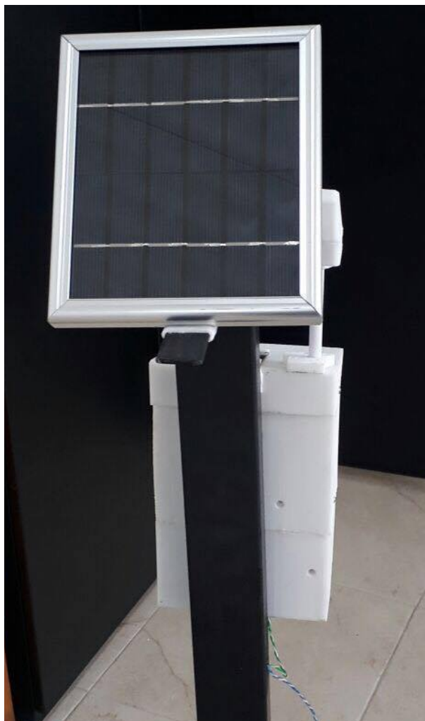
Figura 82. Panel solar sobre soporte de acero junto con la caja que contiene los sensores. Fuente: Autor.
