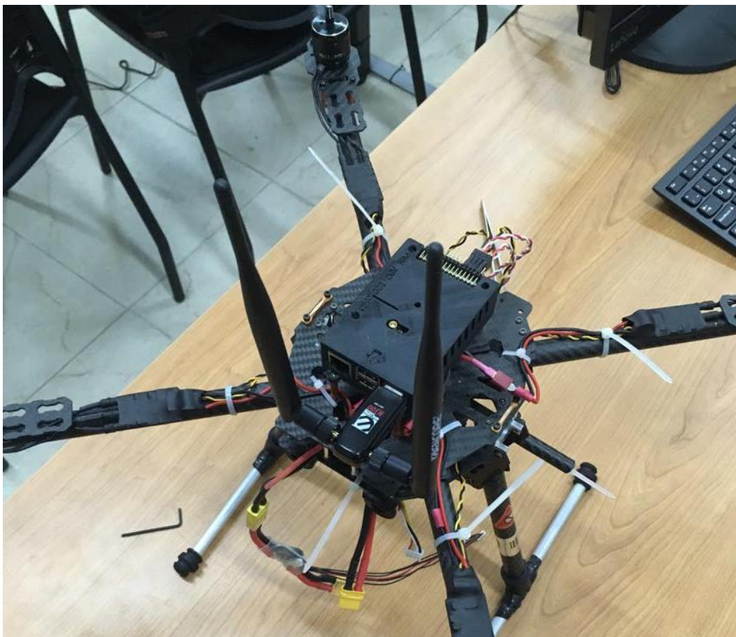
Figura 26. Adaptador de red inalámbrica conectada a la tarjeta Raspberry Pi 2 en el dron. Fuente: Autor.
