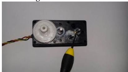
Figura 3.2.2. 6 extracción del circuito
