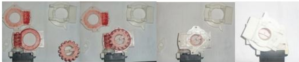
Figura 3.2.2. 13 ensamble piezas de torsión
