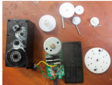
Figura 3.2.2. 8 partes internas del servo HS-805BB
