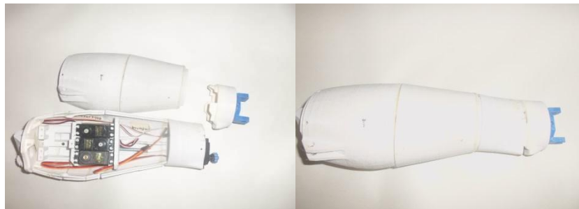
Figura 3.2.1. 11 sub-ensamble antebrazo InMoov
