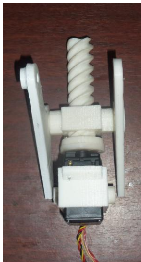
Figura 3.3. 7 montaje del tornillo sin fin con la base del brazo
