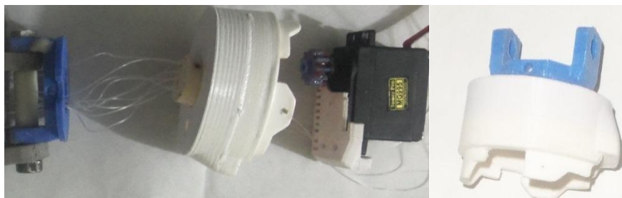
Figura 3.2.1. 7 sub - ensamble pronación- supinación n de la muñeca
