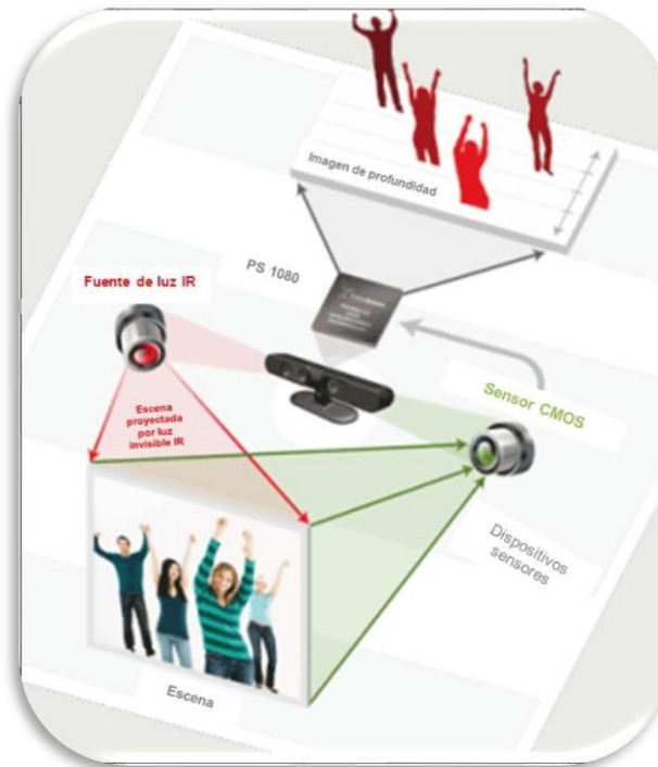
Figura 1.14: Diagrama de la tecnología Kinect patentada por PrimerSense 8
