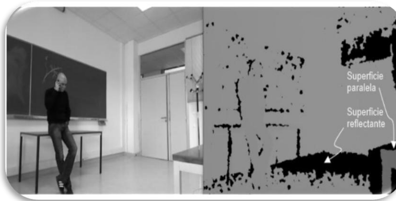
Figura 1.20: Efecto de superficie reflectante y paralela a los rayos de luz 15
