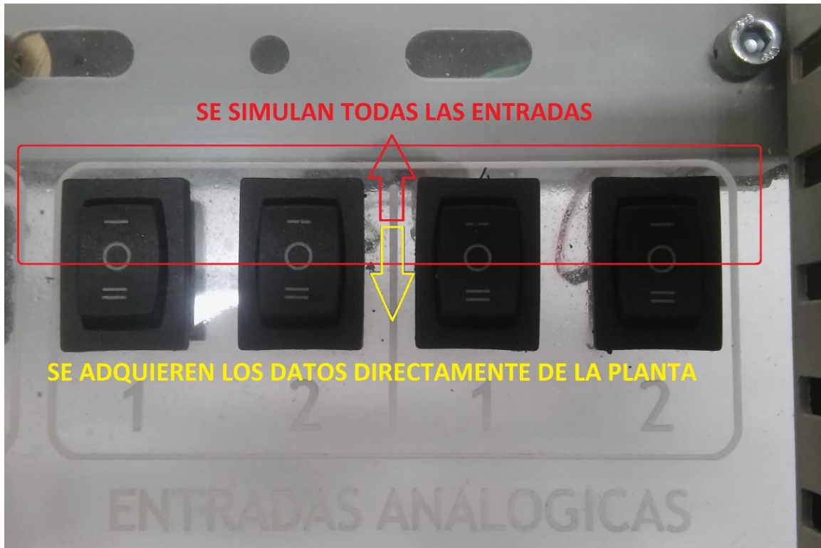
Ilustración 6. Función de los interruptores dobles
