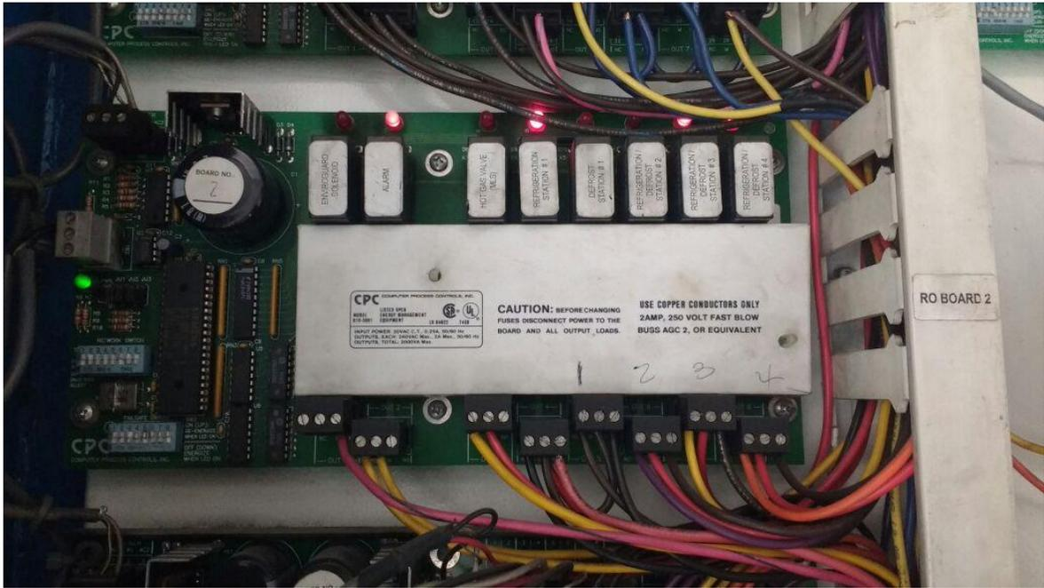
*Ilustración 38. Tarjeta de salidas a relé #2, Fuente: Autor*
