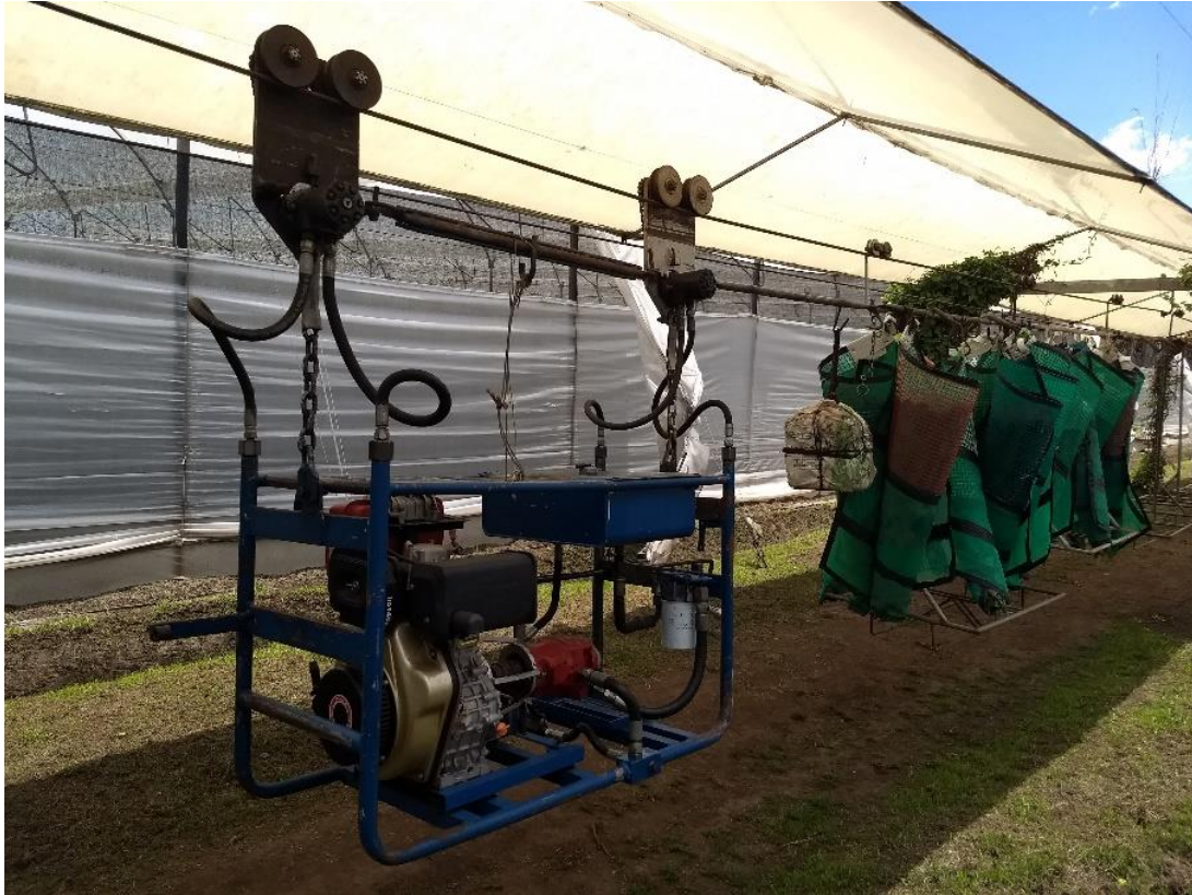
Figura 11. Motor Diesel halando las plataformas.
