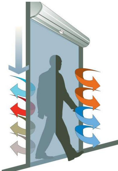
Figura 18. Función de la cortina de aire. Consultado de https://goo.gl/v67AiB .
