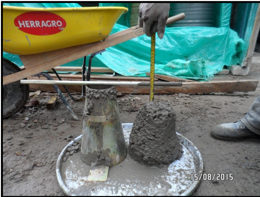
Imagen 80. Ensayo de Asentamiento
