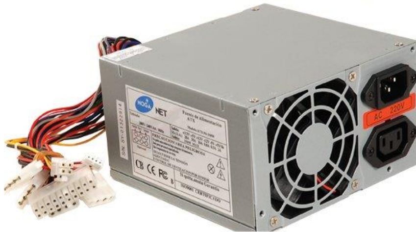
Figura 39 Fuente de voltaje de computador. (“Arquitectura del Computador - Fuentes de Alimentación - Parte 2 de 2,” n.d.)
