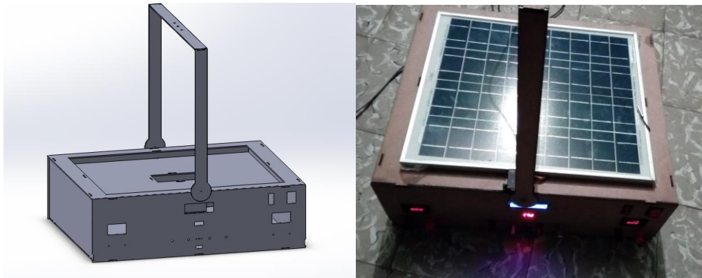
Figura 28 bandeja panel construida y ensamblada
