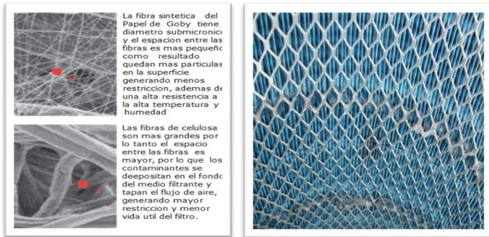
Figura 23. Características Filtro de Aire.
