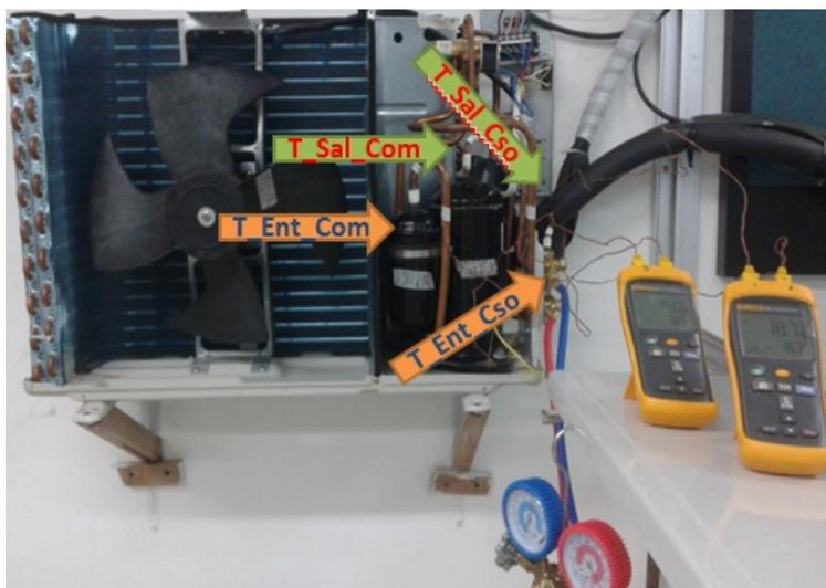
**Figura 4-2:** Montaje para la toma de temperaturas a la entrada y salida del compresor y del colector solar.
