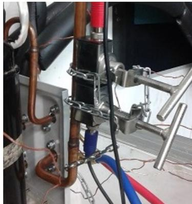
**Figura 4-3:** Montaje del flujómetro sobre la tubería de transporte del refrigerante en la unidad de aire acondicionado híbrido.
