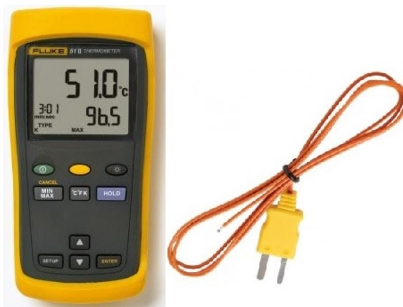
Figura 3-17: Termómetro digital fluke 52 series II. Tomado de [12].
