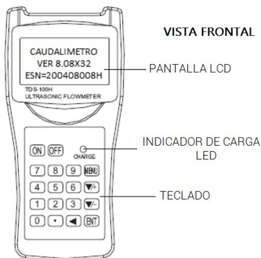
**Figura 3-10:** Vista frontal del caudalímetro TDS 100H,[18].
