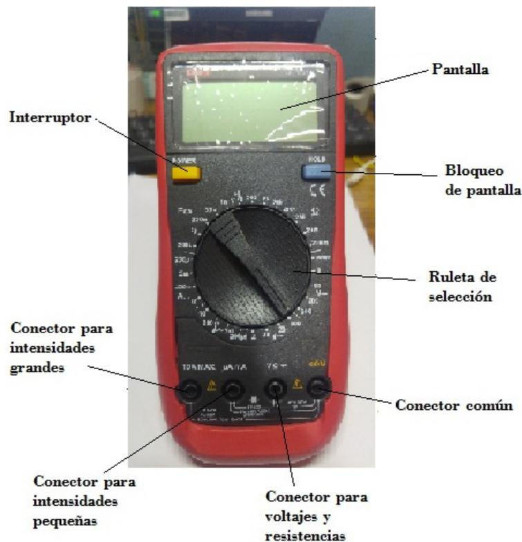
Figura 3-20: Multímetro Unit UT151C, Fuente: Autor
