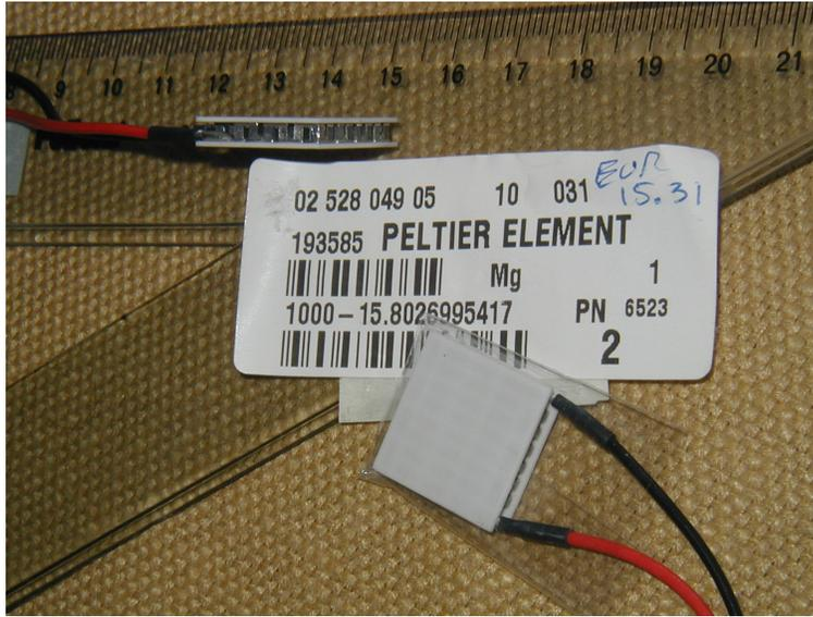
Figura 2-9: Módulos Peltier comerciales. Tomado de [27].
