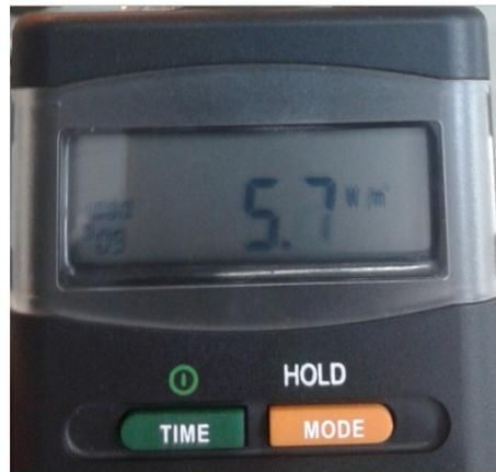
**Figura 4-22:** Radiación a través del cristal. Fuente: Autor.
