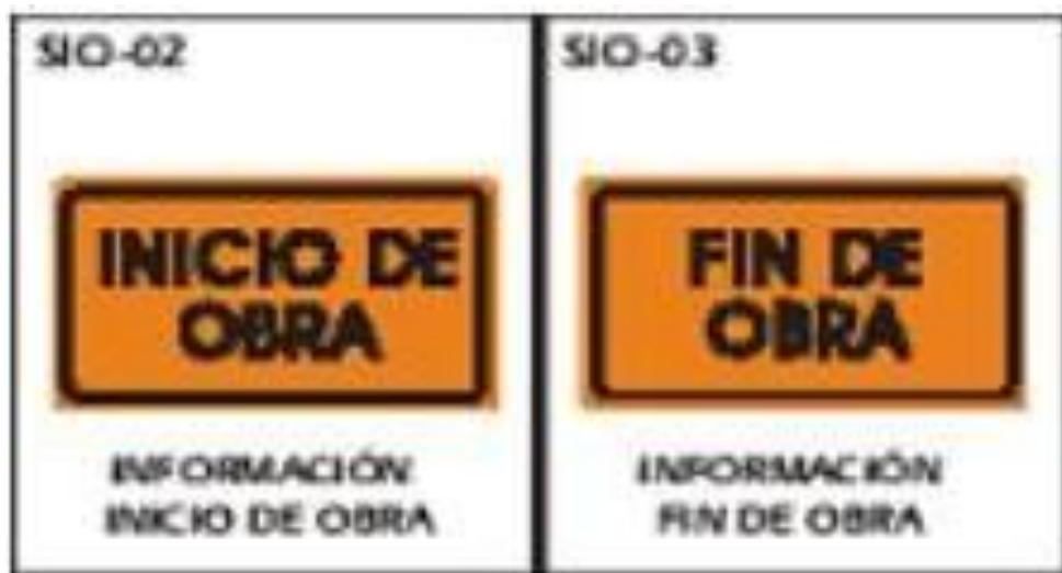
Figura 8: señal de tránsito de inicio y fin de la obra
