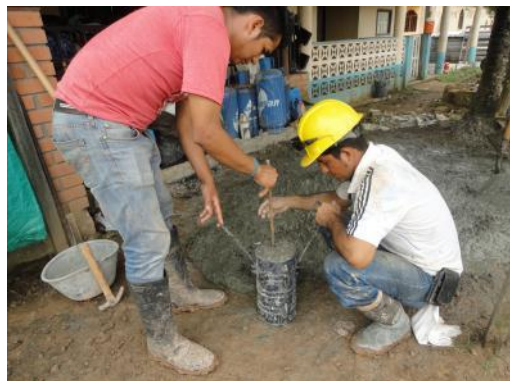
Muestras de concreto
