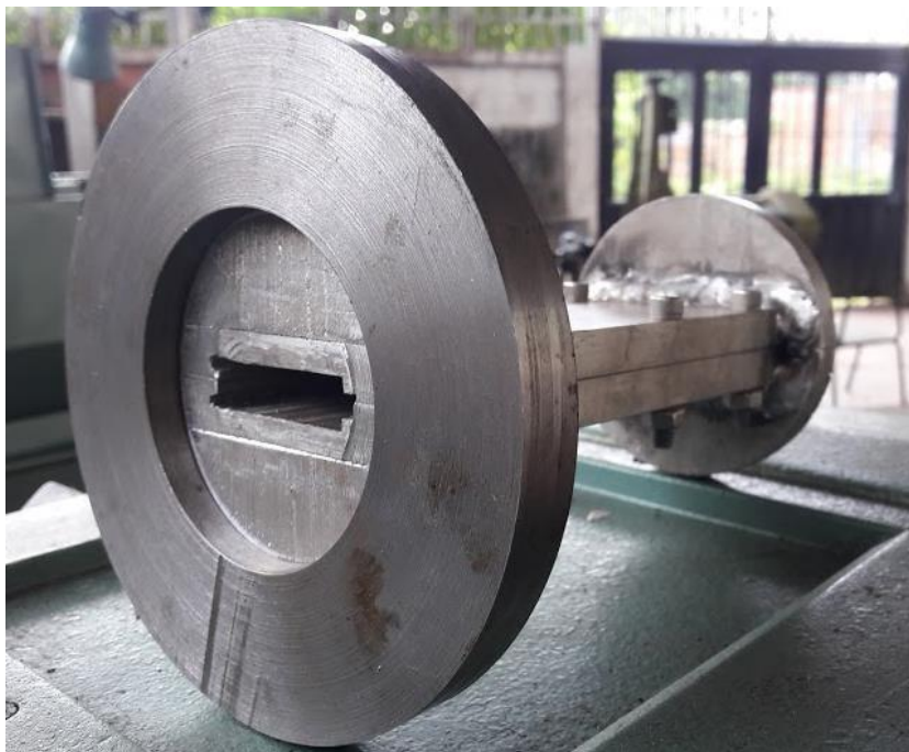
Ilustración 58. Dado con preforma interna. C, Jiménez.
