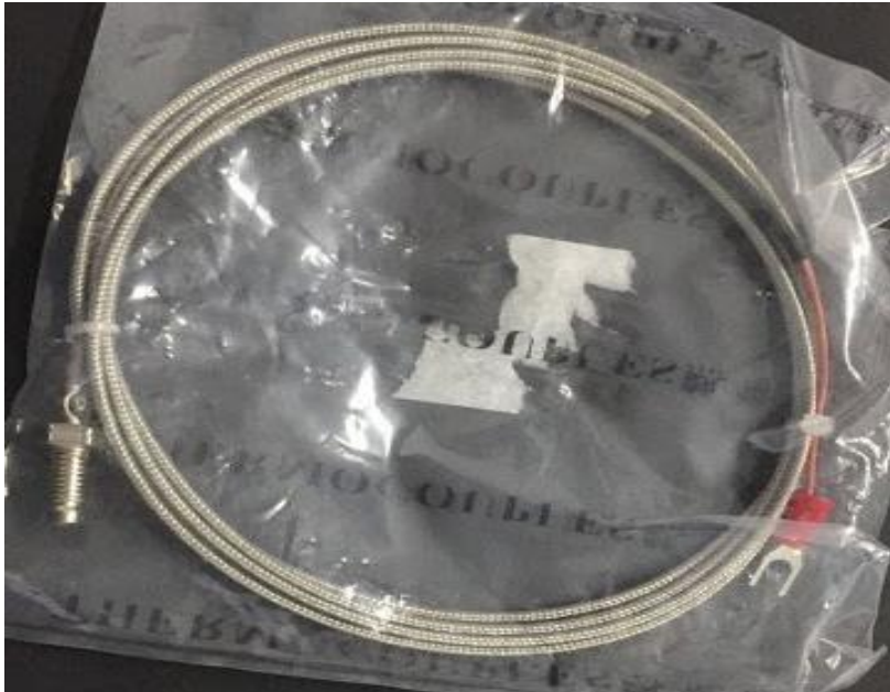
Ilustración 62. Termocupla tipo J para censar la temperatura de la resistencia eléctrica, C, Jiménez.
