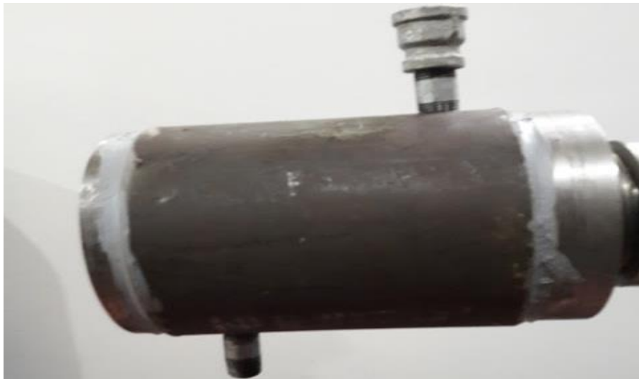
Ilustración 56. Filiera contenedora del dado o preforma. C, Jiménez.
