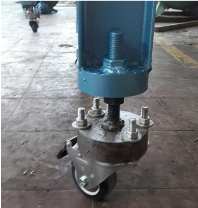
Ilustración 68. Sistema de nivelación de la maquina extrusora, C. Jiménez
