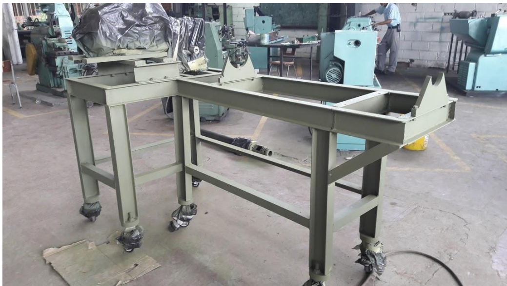
Ilustración 69. Estructura en el proceso de pintura con base anticorrosiva, C. Jiménez.
