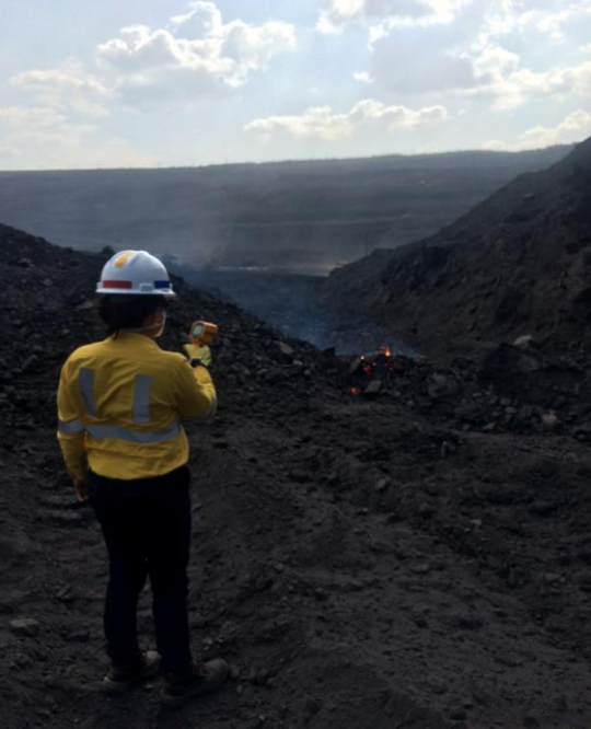
Imagen 30. Cámara termográfica (monitoreo de temperatura).
