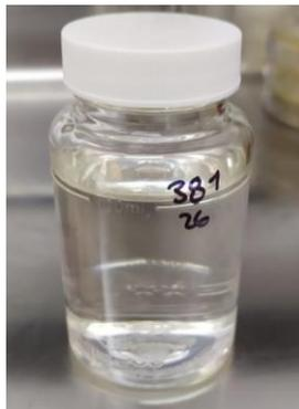
**Figura 11** Frasco Colilert con el agua a analizar y el reactivo para evaluar la presencia de *E. coli*
