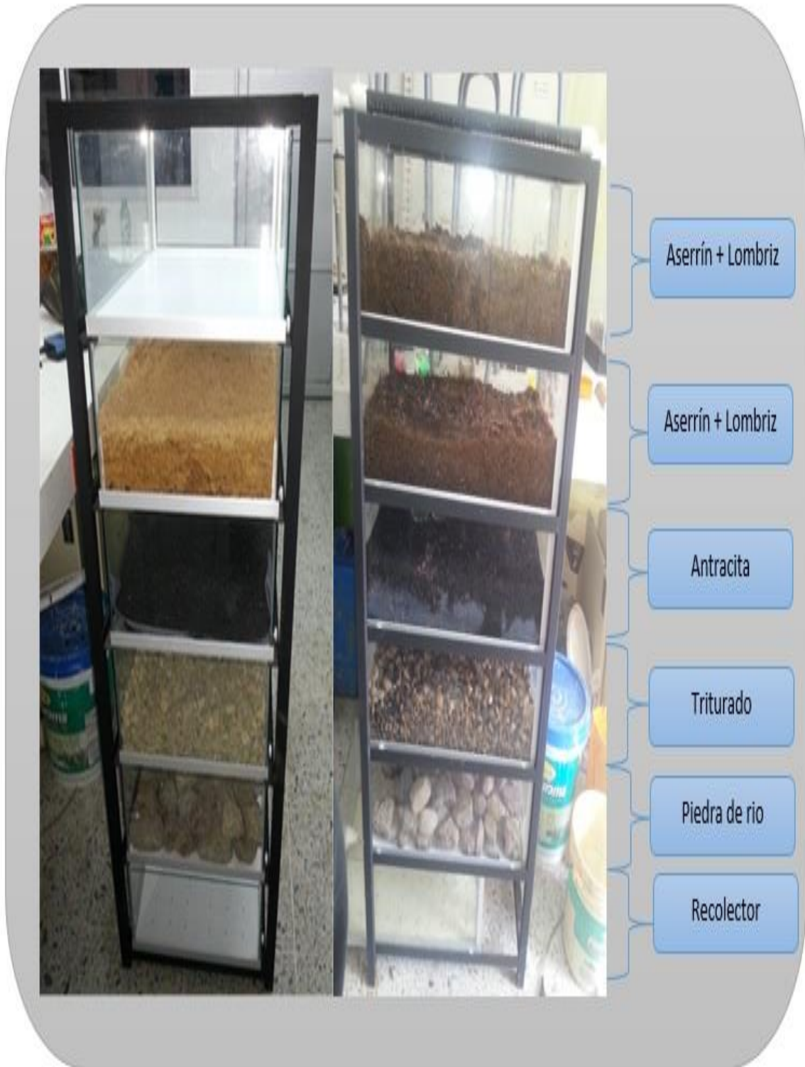
Figura 58. Lombrifiltro con cada Lecho Fuente: Autor
